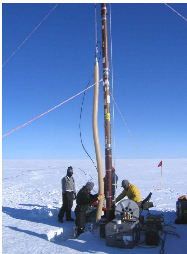
Figure II.5. Descente du manchon en caoutchouc dans le trou de forage pour le prélèvement d'air du névé à Summit, mai 2006.
