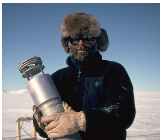
Figure II.6. Tête inférieure du manchon utilisée en mai 2006 pour le pompage d'air à Summit, Groenland.
