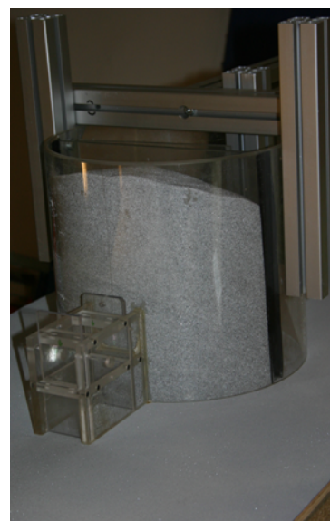
FIG. 4.4 – Système d'alimentation en grains choisi pour notre étude pour générer des écoulements à bords libres sur plan incliné. Il consiste en un réservoir de forme cylindrique (diamètre 100 mm et hauteur 300 mm) avec une porte, dont la hauteur réglable détermine le débit d'alimentation suivant l'inclinaison du plan \theta .
