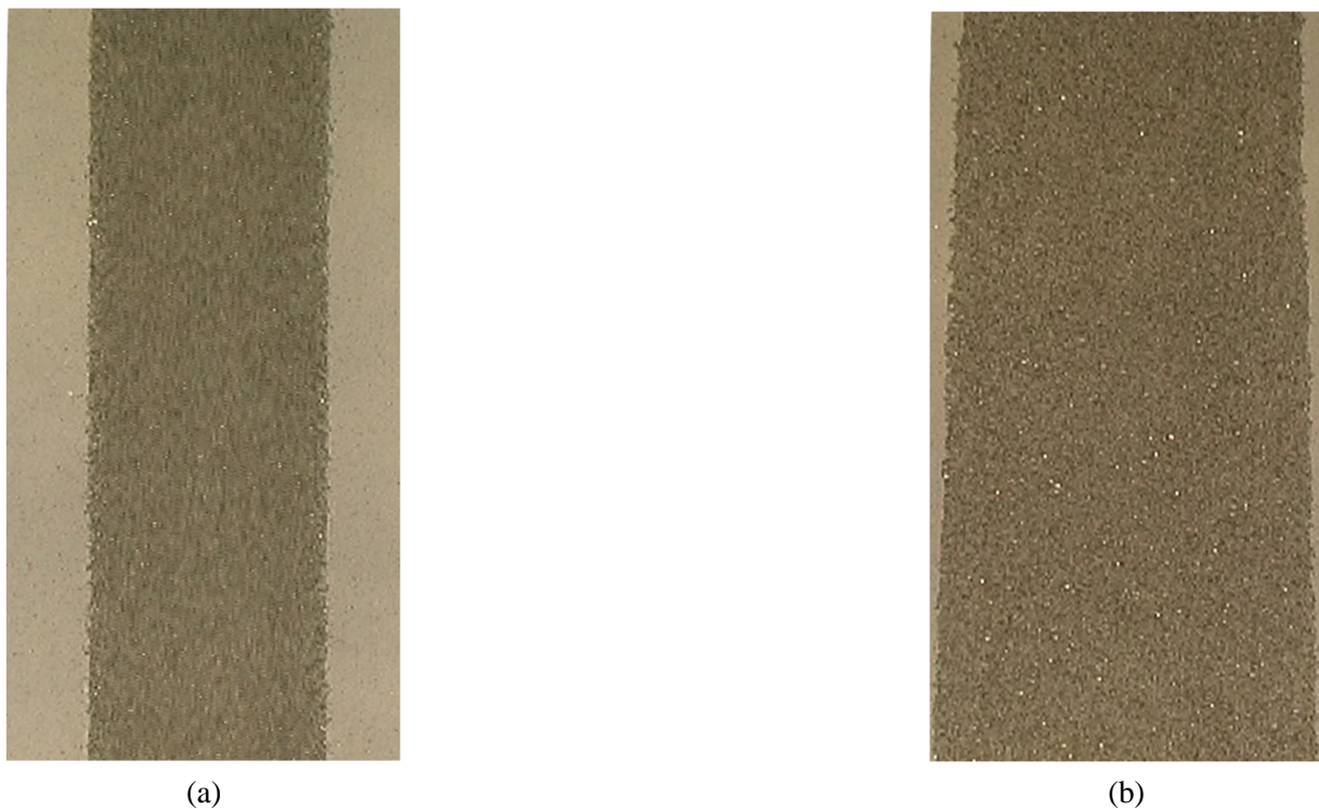
FIG. 4.14 – Photographies d’une portion de l’écoulement de taille 400\text{ mm} \times 500\text{ mm} , prises à deux instants différents. (a) : À t \simeq 100\text{ s} , les bords de l’écoulement sont parallèles. (b) : À t \simeq 4000\text{ s} , les bords s’écartent légèrement formant un angle de 2^\circ avec la direction x . Cela atteste d’une évolution faiblement inhomogène des propriétés de l’écoulement dans la direction longitudinale.
