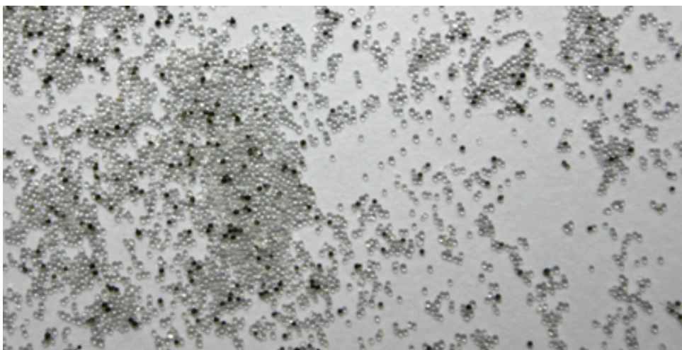
FIG. 4.2 – Photographie d'un échantillon de billes constituant le matériau granulaire, de diamètre moyen d = 0.35 \text{ mm} . Une partie des billes est teinte en noir à l'encre de chine, pour servir de traceurs lors de traitements d'images.
