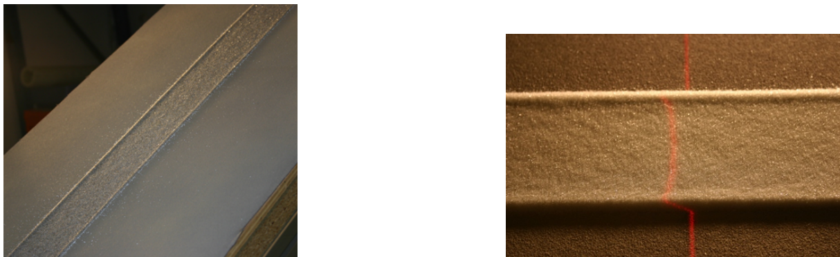
FIG. 4.24 – Photographies de dépôts en forme de “chenal-levées” obtenus après des écoulements à bords libres qui ont duré quelques minutes.
