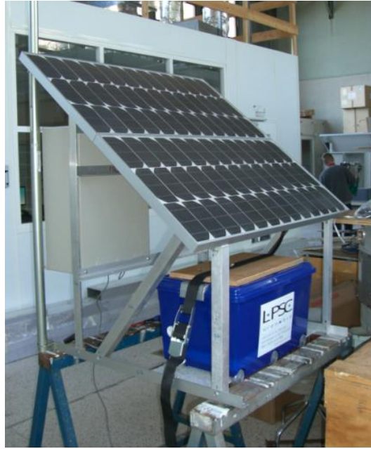
FIG. 6.16 – Vue des panneaux solaires utilisés sur chaque station. Ils sont dimensionnés de façon à pouvoir fournir la consommation de l'électronique embarquée en chargeant les 2 batteries 12V contenues dans le boîtier plastique. La structure métallique des panneaux solaire sert de support au boîtier contenant l'électronique à l'arrière.
