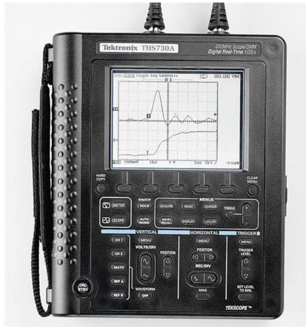
FIG. 6.10 – L’oscilloscope portable Tektronix THS730A est utilisé pour réaliser la numérisation des signaux. Cet appareil robuste permet de numériser 2 voies en fonction du temps à F_e = 250 MHz sur 2500 points. En outre, il possède une entrée de trigger externe pour déclencher l’acquisition des formes d’onde et un protocole de communication par port série RS232 pour transmettre les formes d’ondes enregistrées et régler l’instrument.
