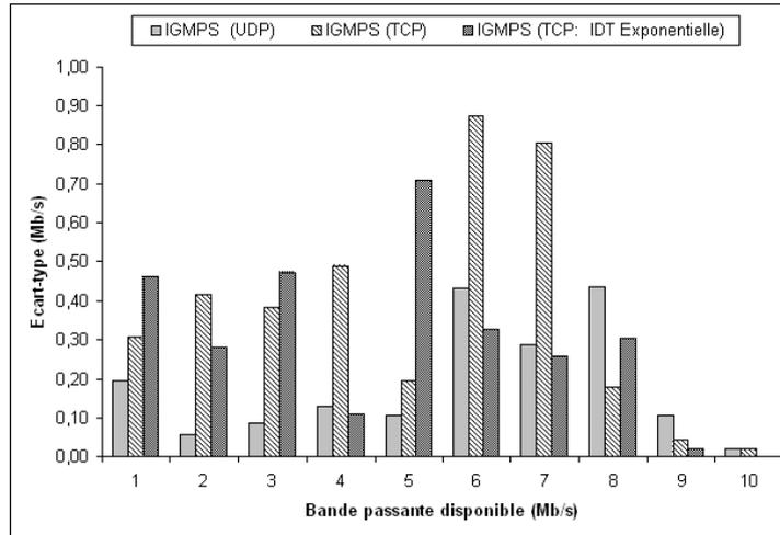
FIG. 3.9 – Ecart-types des résultats de mesures d’IGMPS dans les différents scénarios.
