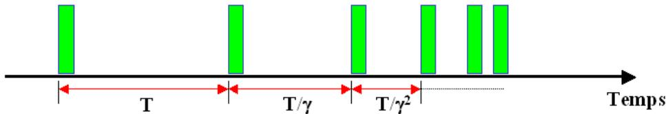
FIG. 2.3 – Chirp : flux de paquets sondes exponentiellement espacés.
