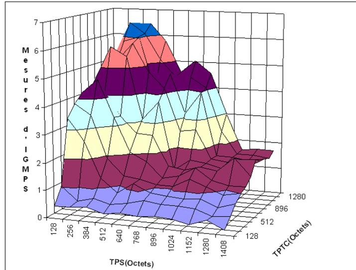
FIG. 3.16 – Effet de la taille des paquets sondes sur IGMPS avec une bande passante disponible de 2 Mb/s.
