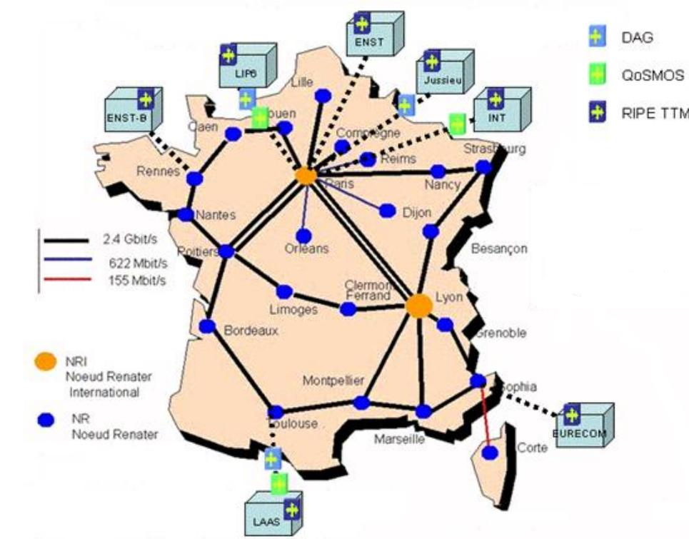
FIG. 1.5 – Architecture de la plateforme de mesure METROPOLIS.
