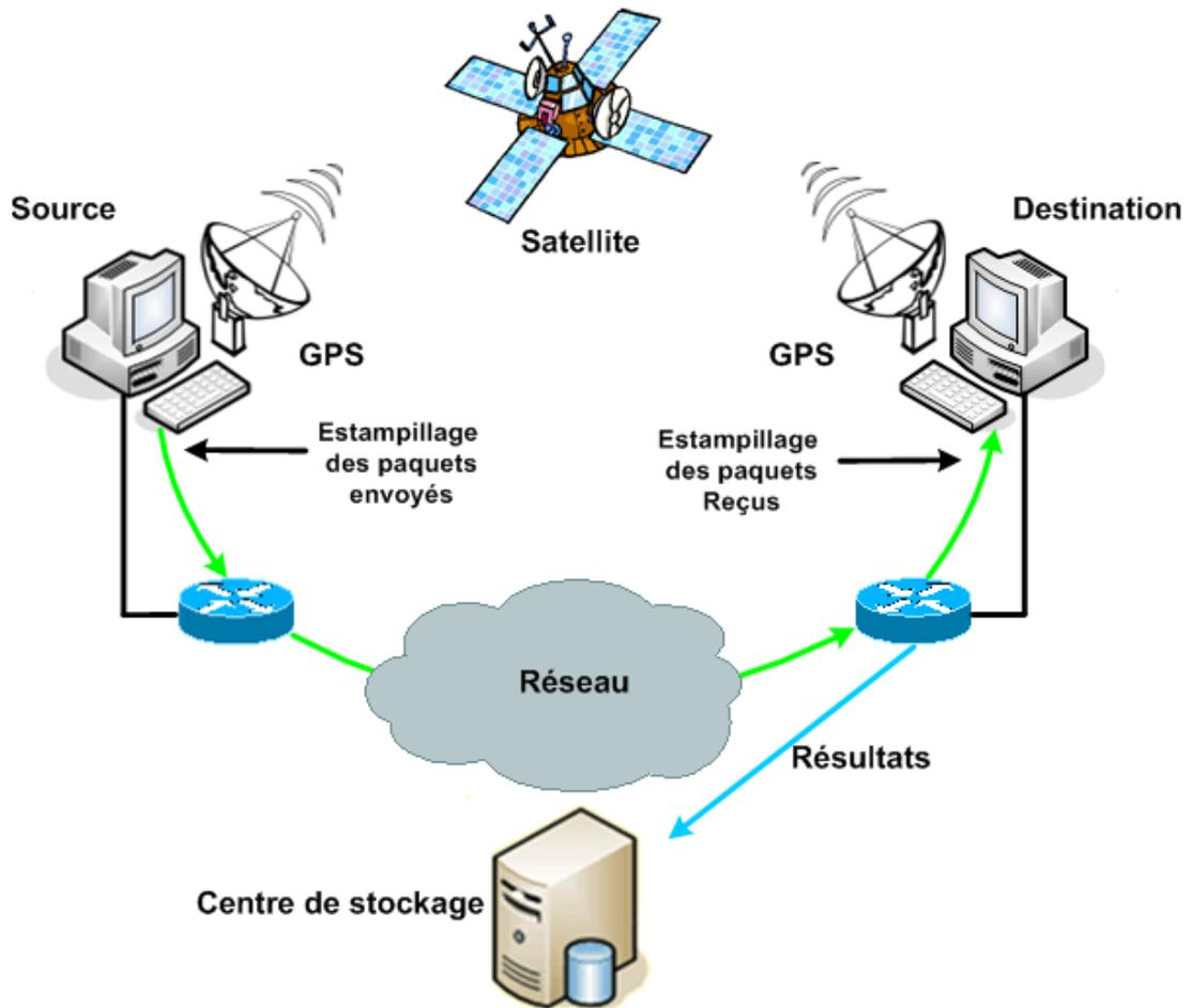
FIG. 1.4 – Architecture de la plateforme de mesure Saturne.
