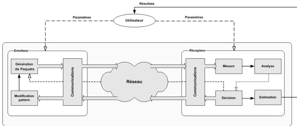
FIG. 3.4 – Architecture d'un outil de mesures unidirectionnelles.
