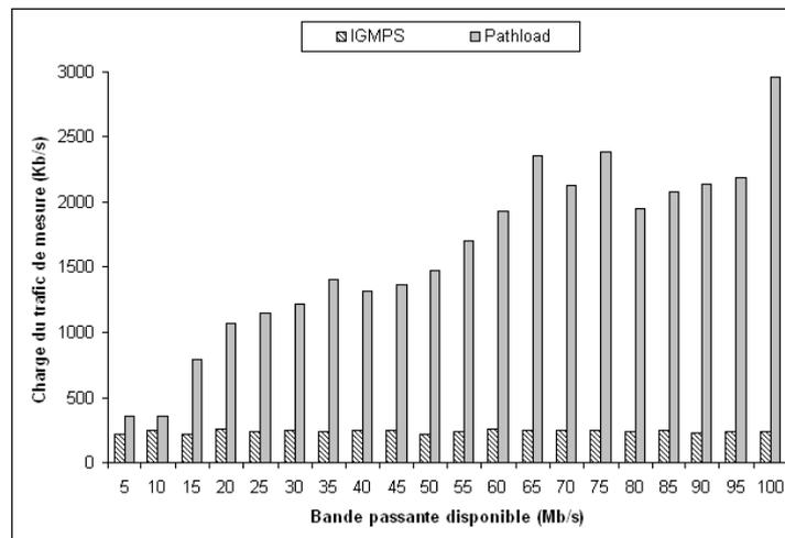
FIG. 3.13 – Charge de trafic de mesure d'IGMPS comparée à celle de Pathload.
