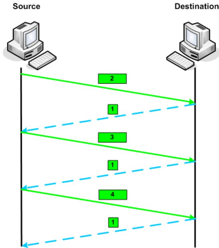
FIG. 1.9 – Mise à profit de l'algorithme "Fast-retransmit" de TCP
