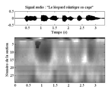
**Figure 120 :** Aérogramme pour la phrase du corpus « Le léopard réintègre sa cage ». Les constrictions sont représentées par les tâches blanches.
