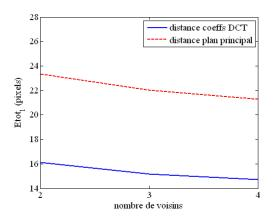
**Figure 23 :** Influence du choix de la mesure de similarité sur l'erreur  $Etot_{l}$ , pour une estimation calculée sans filtrage temporel et à partir de 100 images clefs.
