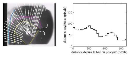
**Figure 56 :** Pour une configuration, représentation en escalier des distances sagittales en fonction de la distance par rapport au bas du pharynx.
