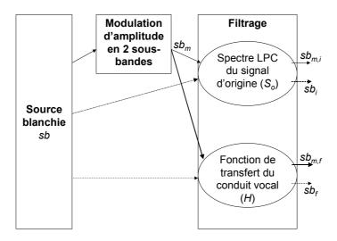
Figure 104 : Schéma-Bloc de synthèse des signaux.
