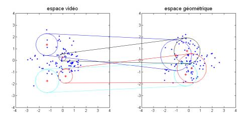
**Figure 14 :** Mise en évidence des irrégularités de projection entre espaces vidéo et géométrique. Les cercles représentent les voisinages (10 plus proches voisins) des points marqués d'une croix rouge.
