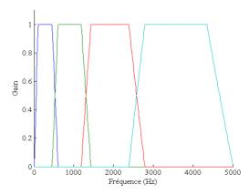
Figure 65: Banc de filtres 4 sous-bandes.
