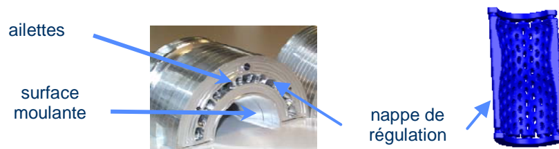
Figure 145 : Canaux conformables et nappes de régulation (Pelaingre, 2003)
