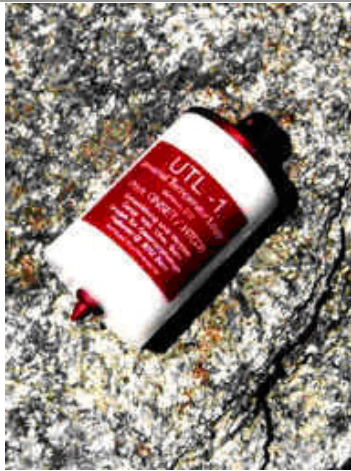
Figure III-1 : Capteur-enregistreur de température miniature UTL-1. Photo Geotest A.G. Miniature temperature datalogger UTL-1.
