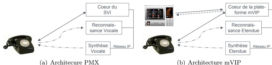
FIG. 3.2 – Evolution de l'architecture PMX vers mVIP, permettant l'intégration du mode vocal dans les interfaces web.
