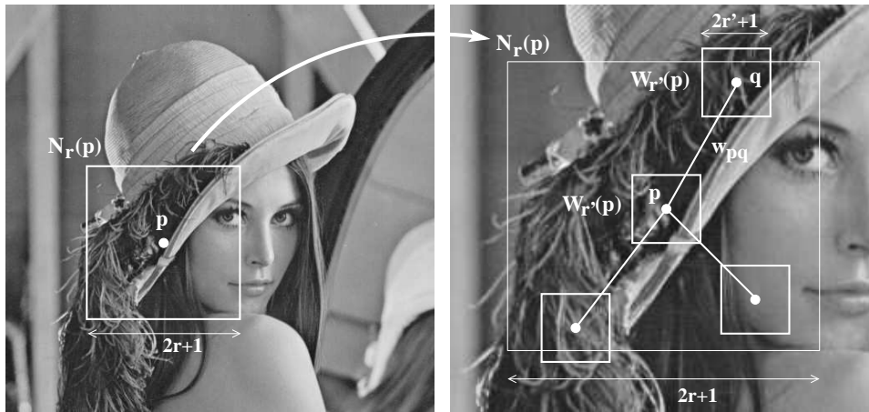
FIG. 5.5: Voisinage \mathcal{N}_r d'un sommet du graphe G_r , et interactions entre les arêtes avec la fonction de poids w_5 ( \mathcal{W}_{r'}(p) = \mathcal{N}_{r'}(p) \cup \{p\} ).
