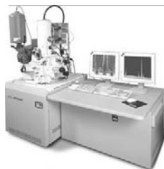
Figure II-5 : Aperçu d'un MEB JEOL 6360A.
