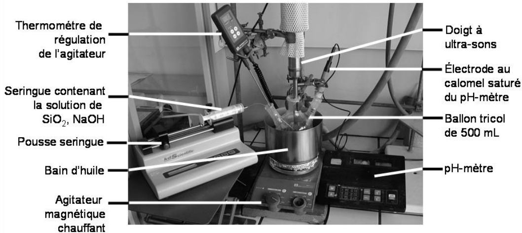
Figure IV-6 : Photo du montage expérimental de synthèse de composites cœur@écorce BST@SiO 2 . (Un deuxième pousse-seringue et une seringue d'acide sulfurique sont ajoutés pour maintenir le pH constant dans le tricol).
