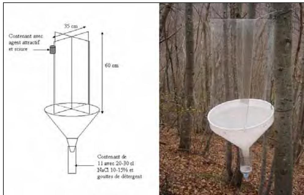
Figure 15. Schéma d'un piège à interception multidirectionnelle (piège VIM) attractif et piège VIM non attractif installé en hêtre (à droite).
