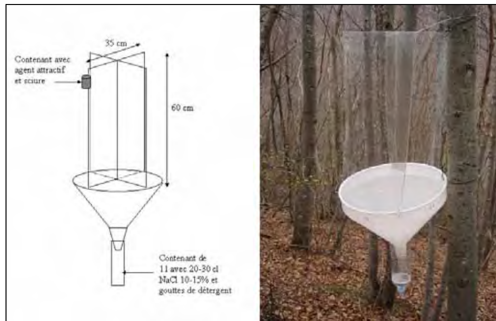
Figure 15. Schéma d'un piège à interception multidirectionnelle (piège VIM) attractif et piège VIM non attractif installé en hêtraie (à droite).
