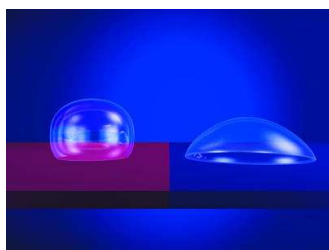
FIG. 2 – Surface hydrophobe ( gauche )/hydrophile ( droite )
