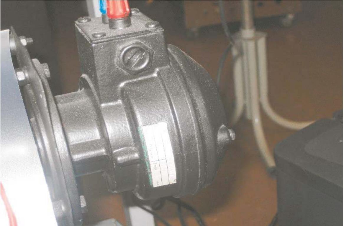
FIG. C.6 – Génératrice tachymétrique
