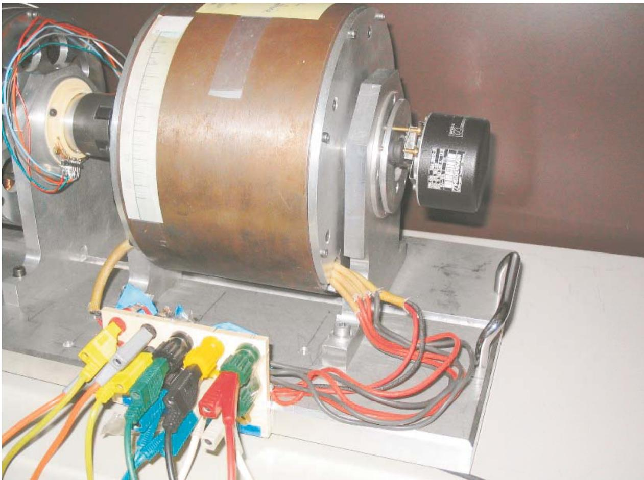
FIG. 3.7 – Banc d'essais de la MSDE
