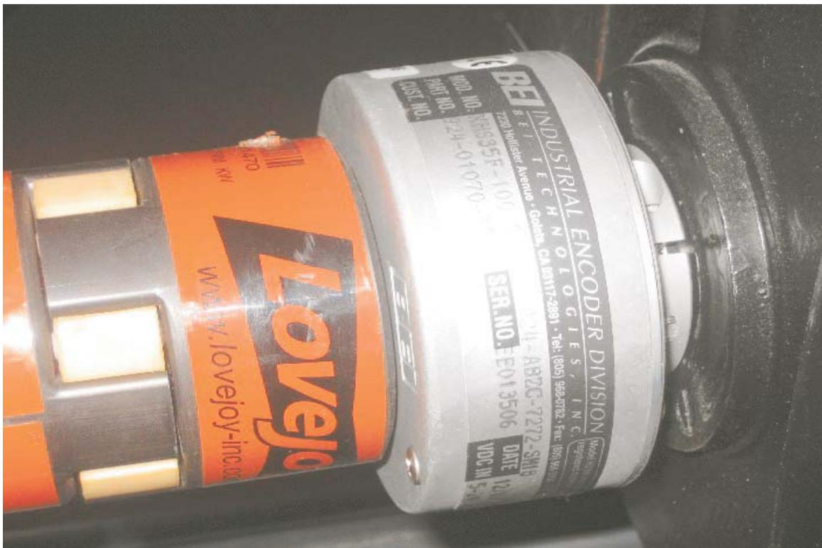
FIG. C.7 – Codeur incrémental pour la mesure de position angulaire du rotor du générateur MADA (ou cascade)
