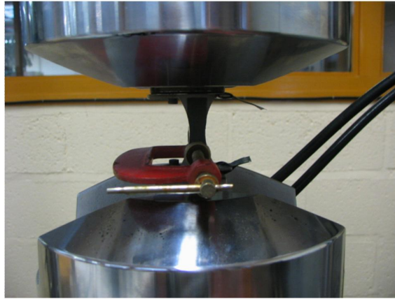
FIG. 1.4.15 – Epreuve patchée équipée d'un serre-joint.
