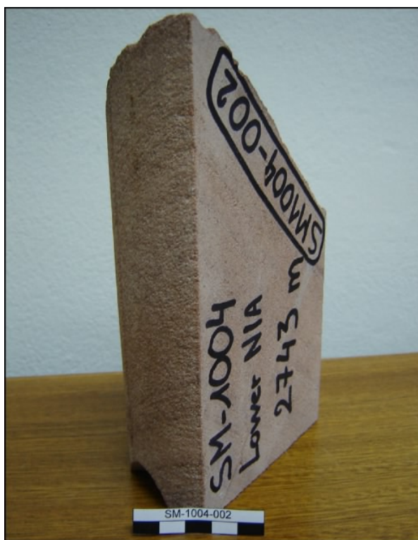
Figure 4. 44 : Carotte SM1004-2 provenant du forage San Martin 1004, fournie par la compagnie Pluspetrol (échelle = 5 cm). Elle provient de la Formation éolienne Nia inférieur qui constitue le principal réservoir exploité pour le gaz dans le bassin de Camisea.
