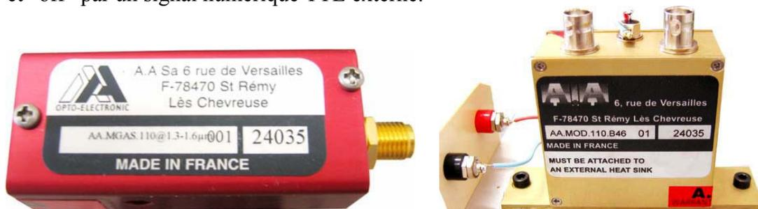
**Figure 4-7.** Modulateur acousto-optique AA.MGAS.110 (à gauche) et son driver AA.MOD-110.B46, fabriqués par A.A. Opto-électronique, fonctionnant à 1,55  $\mu\text{m}$  avec génération interne de 110 MHz.
