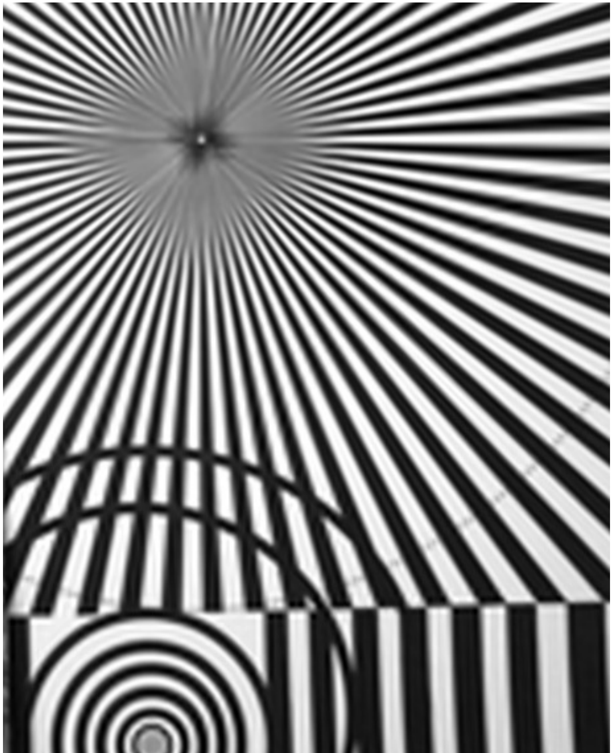
FIG. 7.21 : Agrandissement ( \alpha = 4 , \tau = [0, 0] ) par interpolation WiskI, 10 itérations.
