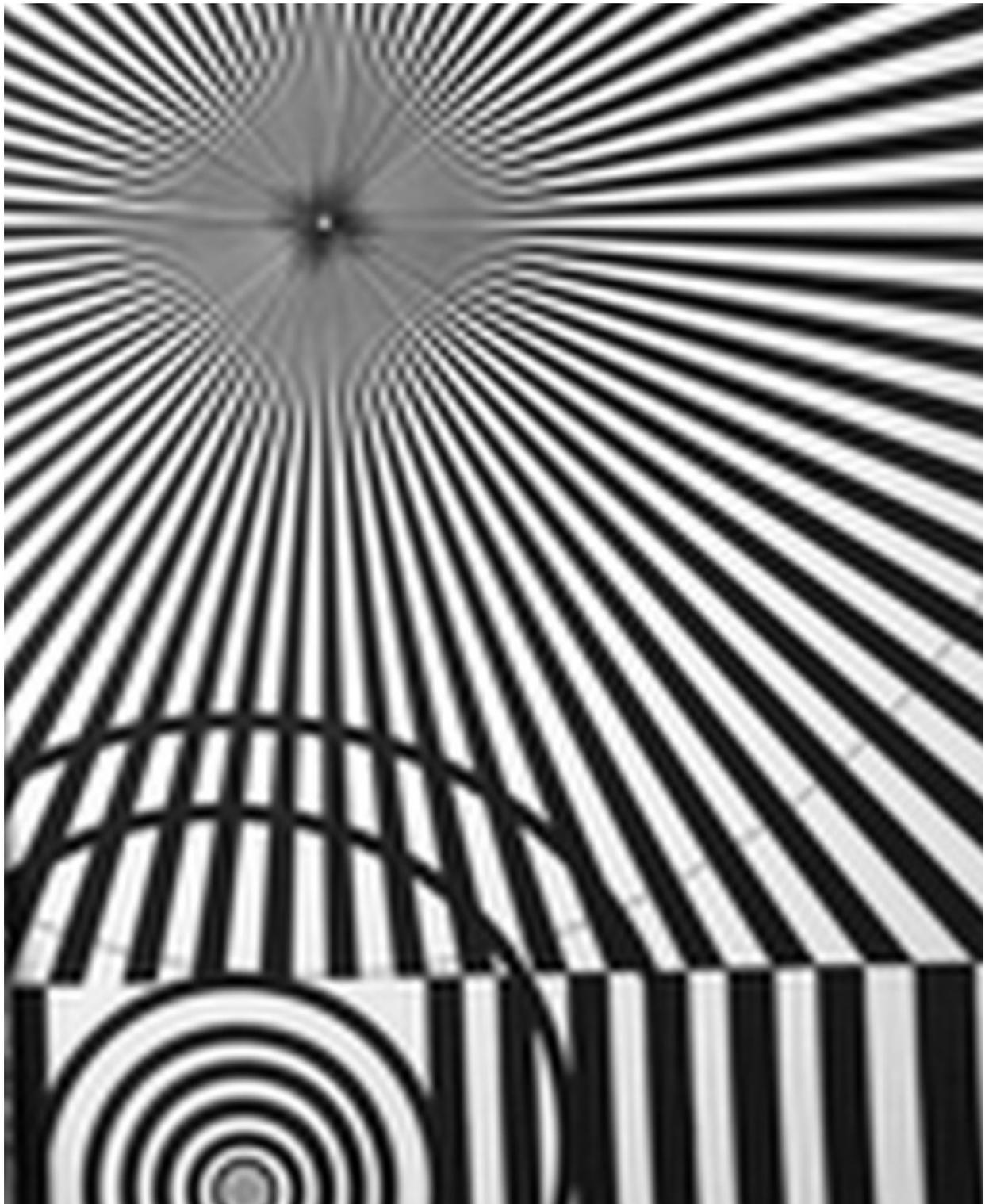
FIG. 7.17 : Agrandissement ( $\alpha = 4$ ,  $\tau = [0, 0]$ ) par interpolation spline cubique.
