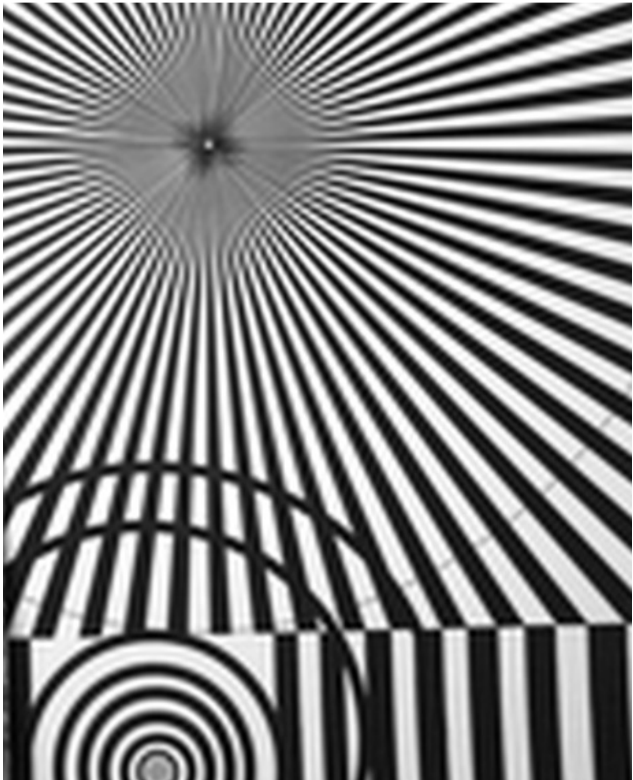
FIG. 7.17 : Agrandissement ( \alpha = 4 , \tau = [0, 0] ) par interpolation spline cubique.
