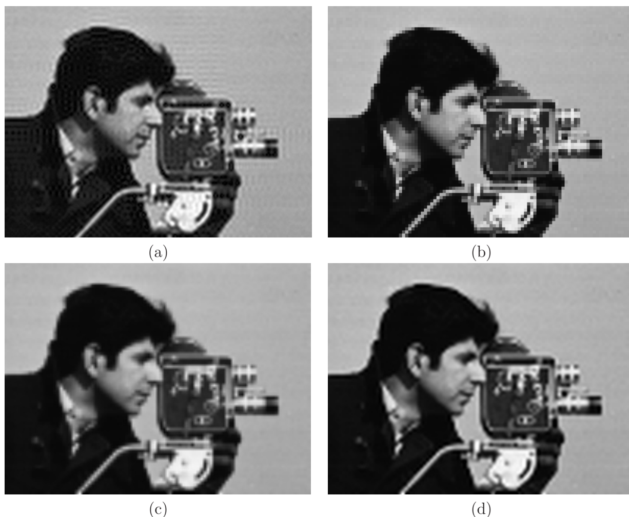
FIG. 6.1 : Agrandissement \times 4 par interpolation (a) sinus cardinal (b) au plus proche (c) bilinéaire (d) spline cubique, d'une portion de l'image Camera .
