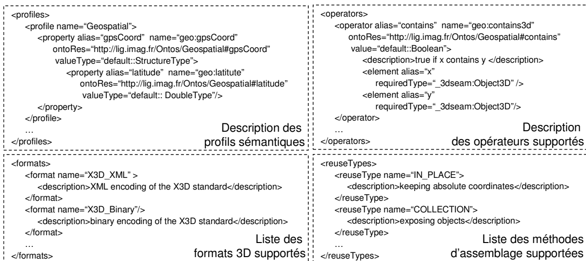
Figure 7.2 Exemple de description XML de profils, opérateurs, formats et méthodes d'assemblage de scène supportés par la plate-forme de réutilisation.
