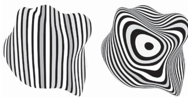
FIG. 4.8 – Exemples de surfaces doublement incurvées recouvertes d’une texture anisotrope (tirée de [TOKK04]) ; à gauche l’orientation de la texture suit une direction verticale constante ; à droite l’orientation de la texture suit la direction de la plus petite normale à la courbure ; la forme est parfaitement perceptible malgré l’anisotropie de la texture.
