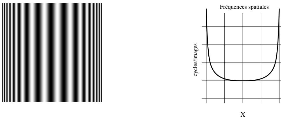
FIG. 2.13 – Texture d’une surface courbe et traduction de la variation de celle-ci dans le domaine fréquentiel.
