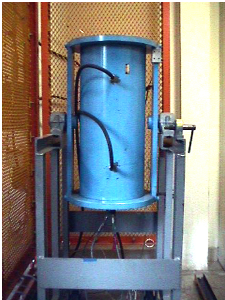
Figure 12 : Photo de l'autoclave à chauffage interne utilisé pour nos expérimentations. Pendant l'expérience, il doit être maintenu en position verticale (comme ici) pour que le système de trempe rapide puisse fonctionner.
