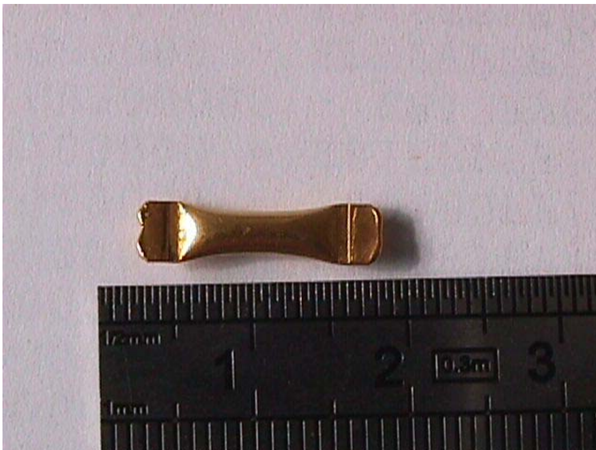
Figure 8 : Photo d'une capsule en or soudée prête à être placée dans le porte-échantillon.
