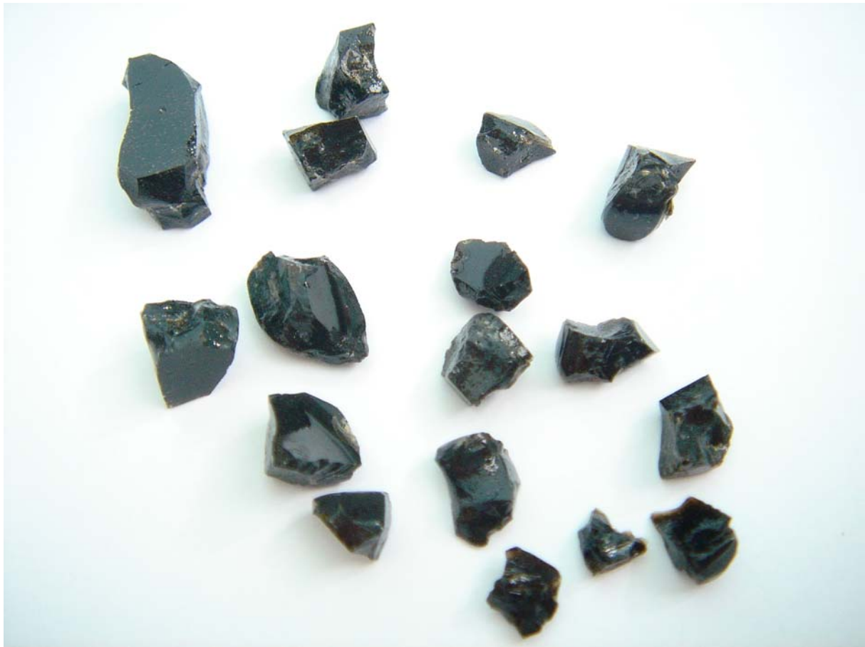
Figure 7 : Photo de fragments de verre de double fusion de l'échantillon Pin Dac après trempe rapide du creuset de platine (le plus gros fragment en haut à gauche mesure 1.5 cm de long).
