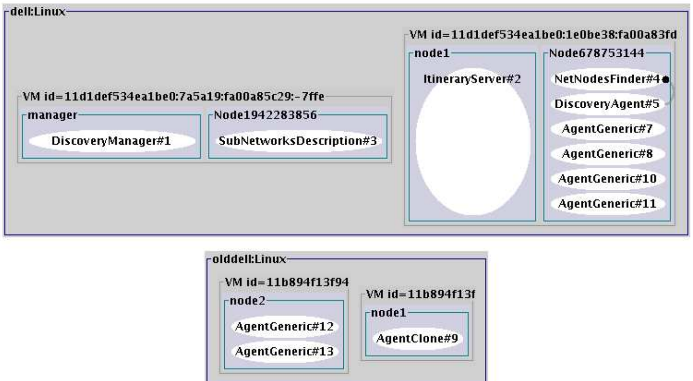
FIG. 5.10 – Les services de la plate-forme et des agents mobiles d'administration vus par IC2D
