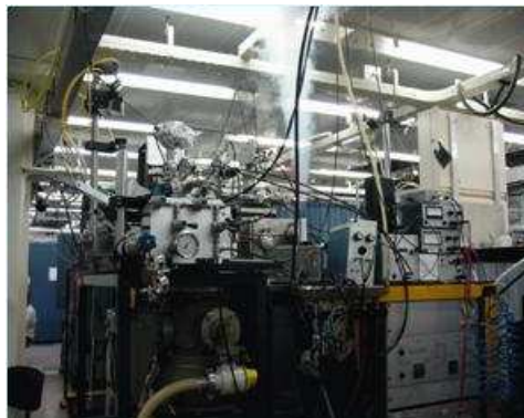
Figure 7.10 – Photo du dispositif expérimental de LCVU pour la génération de la sixième harmonique et la photo-ionisation des molécules.
