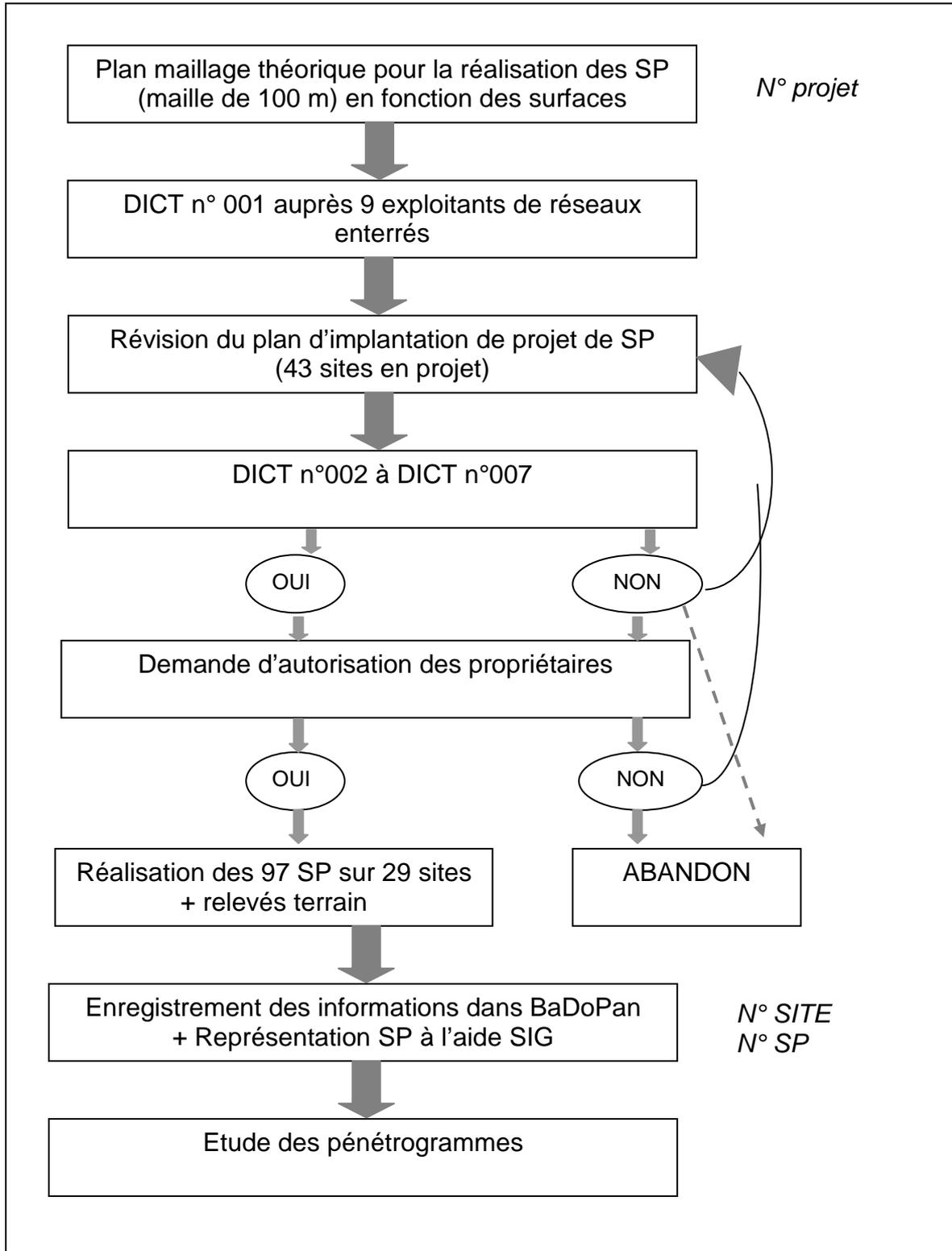
Fig. 41 - Schéma récapitulatif des étapes de l'acquisition des données pénétrométriques utiles à l'évaluation à l'échelle de la ville
