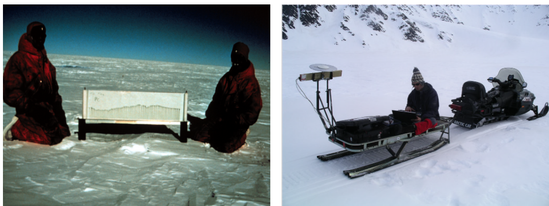
FIG. 3.9 – Deux méthodes de mesure de profils de rugosité des surfaces de neige : à gauche l'utilisation du rugosimètre à aiguille, à droite un distancemètre laser installé sur un scooter des neiges.
