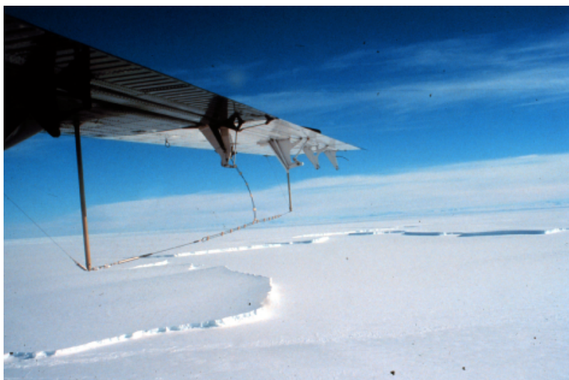
FIG. 6.1 – Antenne radar installée sous les ailes d’un avion Twin-Otter.
