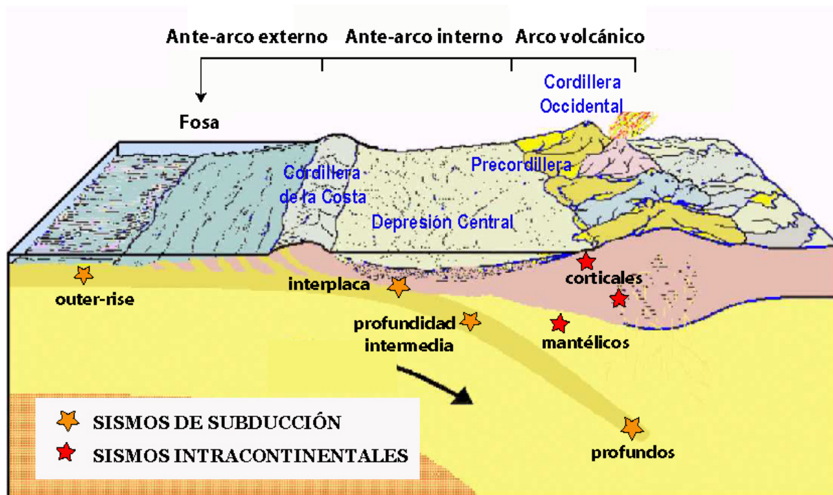
Figura 3.2: Los dos tipos de sismos en contexto de subducción: eventos de subducción (estrellas naranjas) y eventos intracontinentales (estrellas rojas). Se especifican las distintas categorías de cada tipo.
