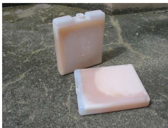
Figure 30 : Briquette en polyoléfine remplie de MCP
