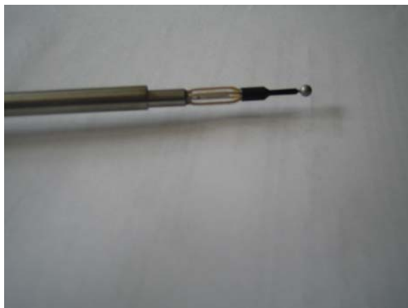
Figure 151 : Anémomètre à film chaud
