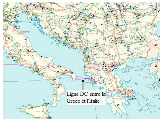
Figure 1.11 Liaisons électriques en courant alternatif et courant continu entre la Grèce et l'Italie
