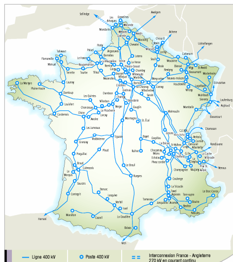
Figure 1.14 Réseau de transport 400 kV de la France (RTE [2007]), exemple de réseau maillé
