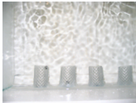
Figure 2.4 : Photographie de l'injection d'eau par les quatre tuyaux.
