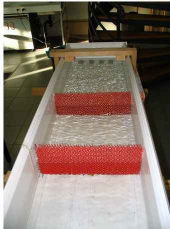
Figure 2.5 : Influence des plaques en nids d'abeilles sur la diminution des tourbillons engendrés par la pression de l'injection d'eau.
