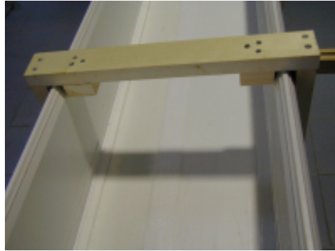
Figure 2.2 : Photographie de la section de la maquette construite avec des planches PVC.
