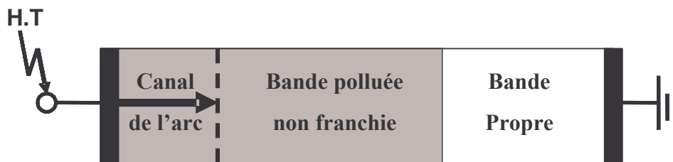
Figure II.1: Configuration d'une surface isolante constituée de deux bandes (polluée et propre).
