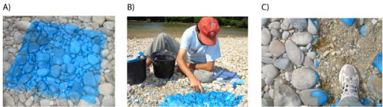
Photographie 2.4 - Étapes du protocole d'échantillonnage Paint and Pick : (A) parcelle initiale peinte, (B) collecte manuelle des particules de surface peintes et (C) parcelle à la fin de l'étape de collecte.
