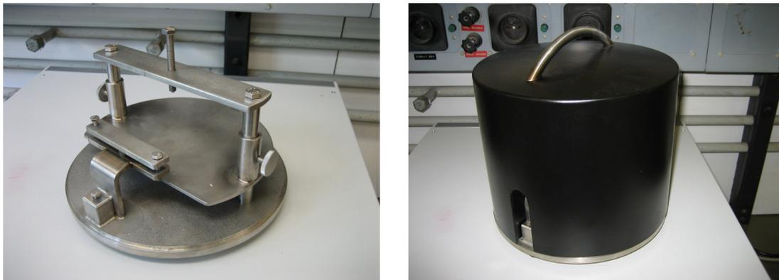
**Figure 4.5 :** Plateau récepteur de l'échantillon et son couvercle isolant
