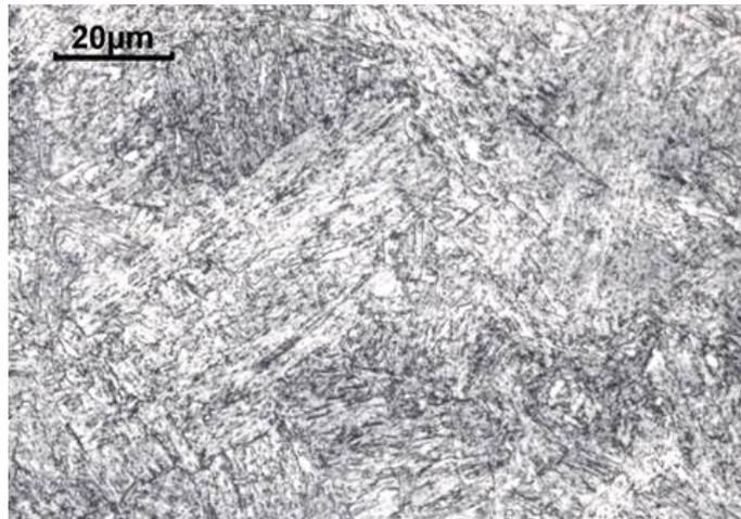
**Figure 1.48 :** Microstructure du disque à cœur après essai [Hamam\_2002]
