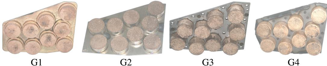
**Figure 1.22 :** Les quatre garnitures testées contre des disques TGV (document SNCF)
