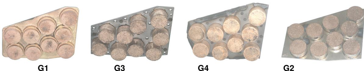
**Figure 4.12 :** Disposition des plots pour les quatre garnitures G1 à G4
