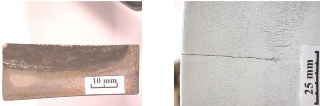
**Figure 1.4 :** Exemple de fissure rectiligne débouchante (document SNCF)
