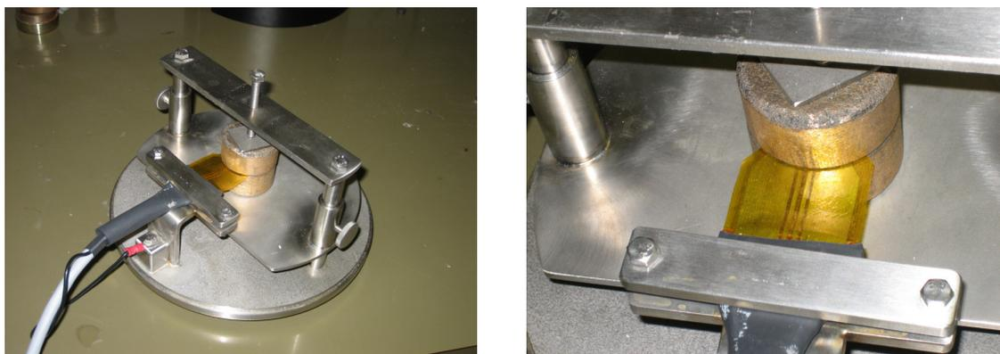
**Figure 4.6 :** Sonde utilisée pour la mesure de conductivité thermique ( $\lambda$ )
