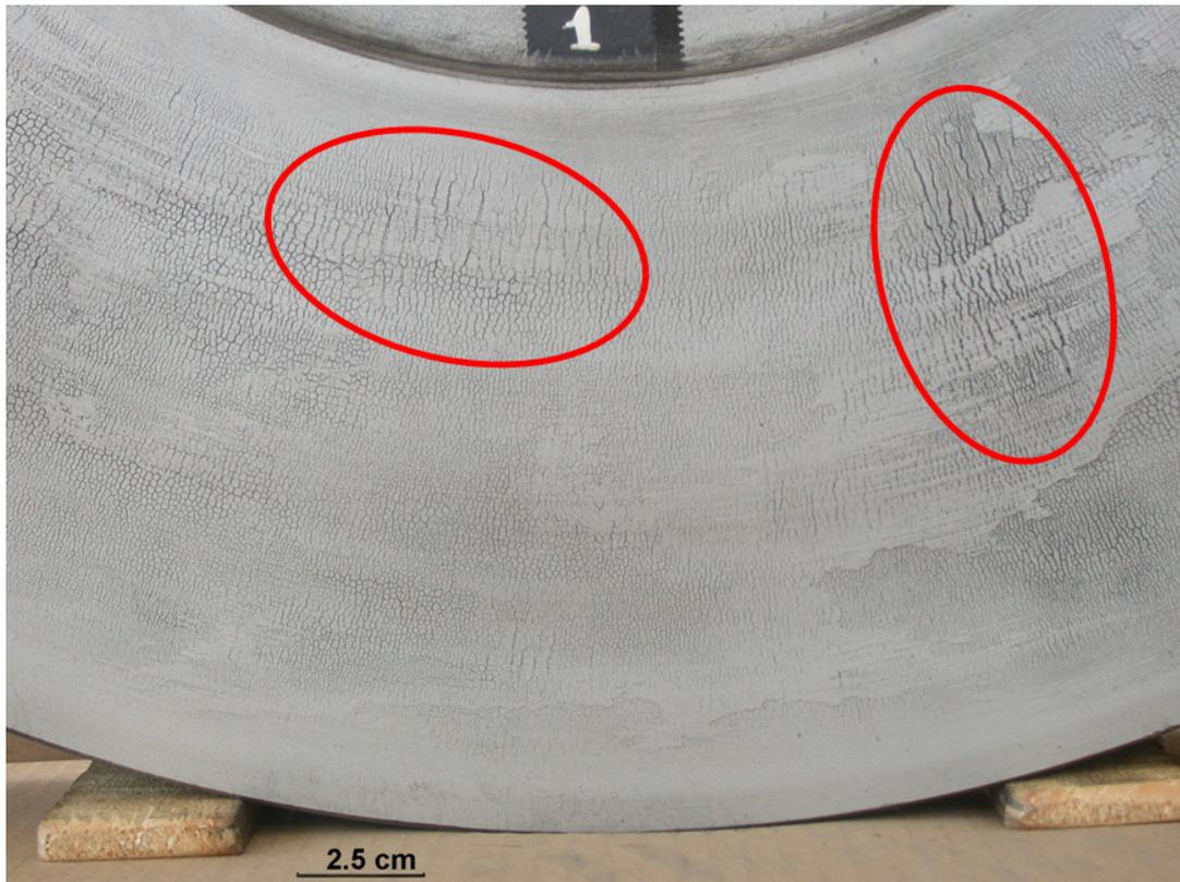
**Figure 1.35 :** Observation par magnétoscopie de la répartition du faïençage sur le disque équipé de garnitures G4
