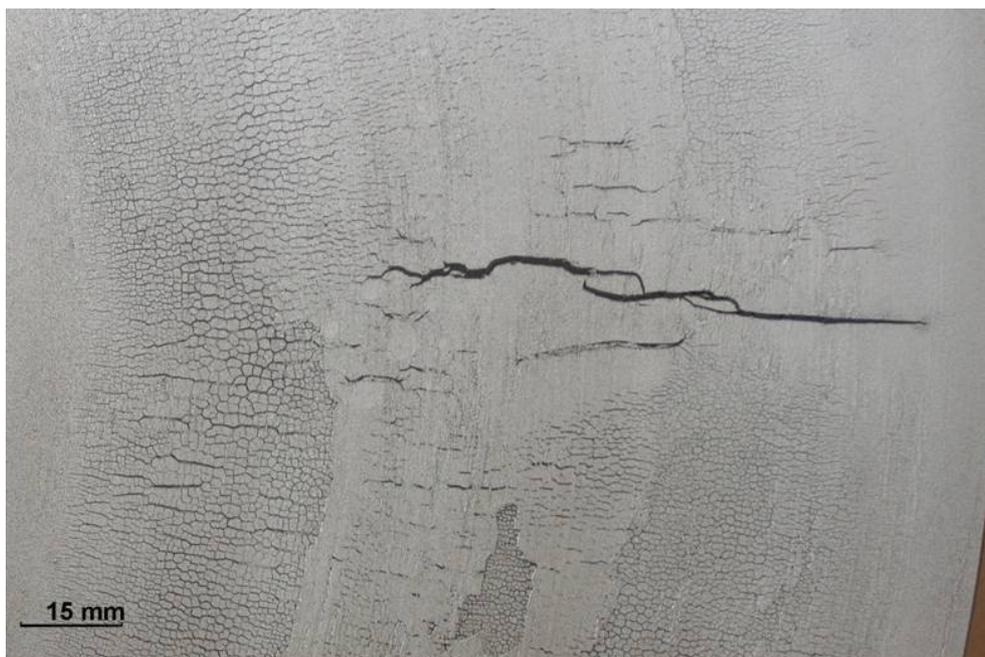
**Figure 1.36 :** Observation par magnétoscopie de la répartition du faïençage autour d'une fissure macroscopique sur le disque freiné par la garniture G4.
