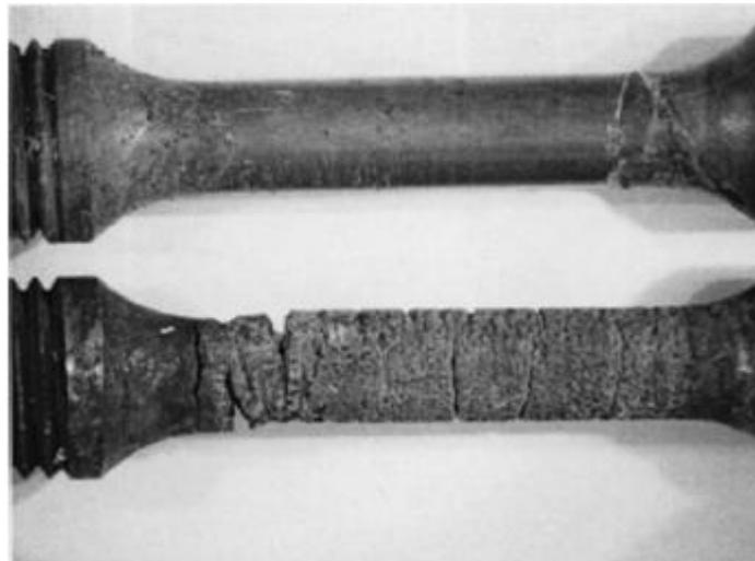
**Figure 1.11 :** Eprouvettes de type 304 ayant séjourné dans un bain d'acide, l'échantillon supérieur était exempt d'effort, l'échantillon inférieur a été soumis à une charge constante [Bosch\_2005].
