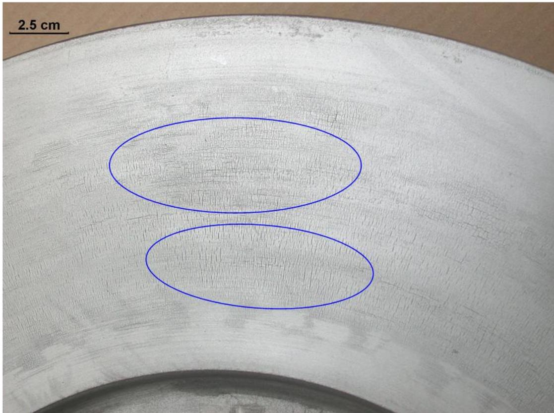
**Figure 1.33 :** Observation par magnétoscopie de la répartition du faïençage sur le disque équipé de garnitures G1 puis G2
