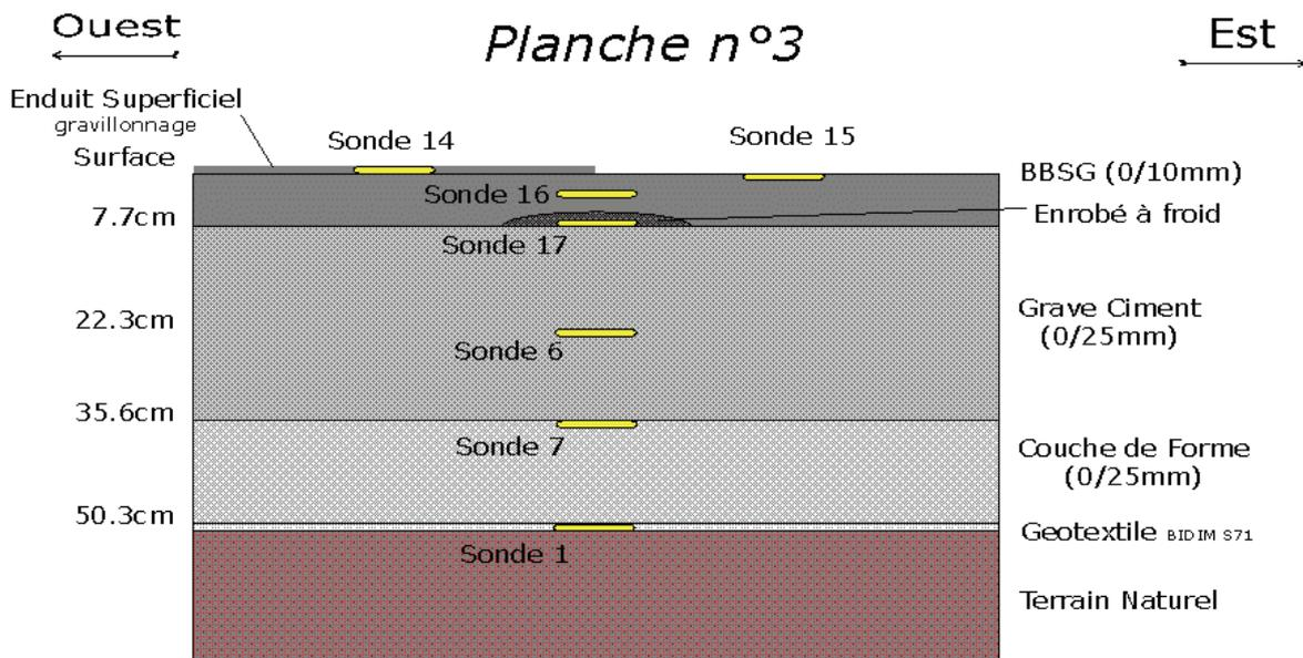
Figure A.4 : Description de la structure de la chaussée n°3.
