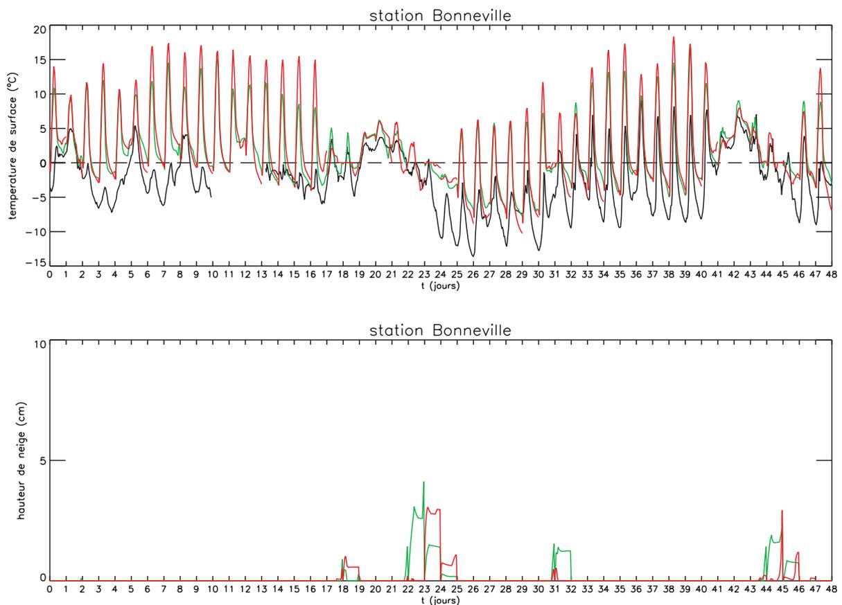
**Figure 6.3 :** **a)** Comparaison pour la période du 1 janvier au 18 février 2005 de la température de surface mesurée sur la station Bonneville (A40) (—) avec la température de surface simulée avec le forçage analysé (—) et avec la prédiction (—) ; **b)** Simulations des hauteurs de neige sur la chaussée avec le forçage analysé (—) et en prédiction(—).
