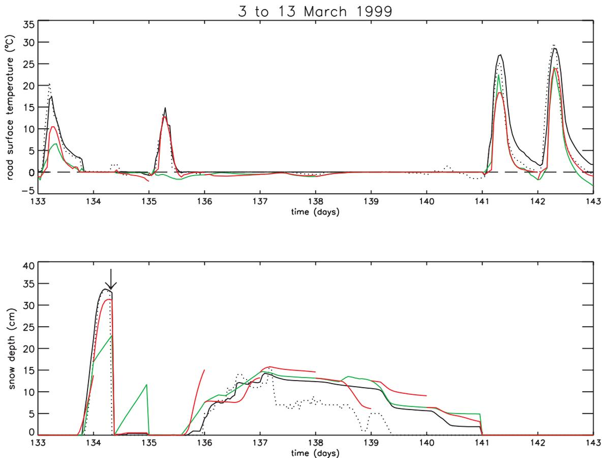
**Figure 5.1 :** a) Comparaison pour la période du 3 au 13 mars 99 de la température de surface mesurée (---) avec la température de surface simulée : avec le forçage observé (—), avec le forçage analysé (—) et avec le forçage prévu (—); b) même comparaison pour la hauteur de neige.
