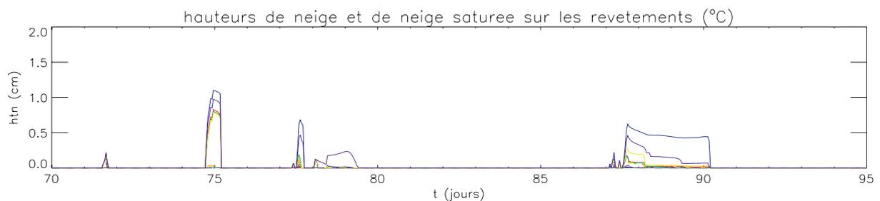
**Figure 4.19** : hauteurs de neige (trait continu) et de neige saturée (trait discontinu) sur les différents revêtement : BBSG type A (rouge), BBDR type A (vert), BBDR type A dépigmenté (bleu), BBSG type B (jaune), BBDR type C (violet), avec des déneigements intégrés dans le modèle le 26 et le 29 février 2004 (t =75 et 78 jours).
