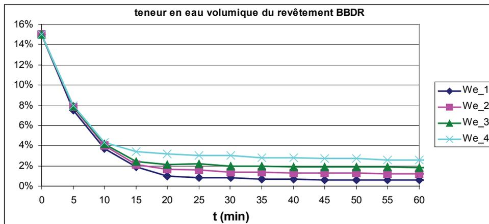
**Figure 4.14** : Comparaison de la teneur en eau liquide volumique au sein d'un revêtement drainant, pour plusieurs valeurs du coefficient de rétention :  $b=0.5$  (We\_1),  $b=1$  (We\_2),  $b=1.5$  (We\_3) et  $b=2$  (We\_4).
