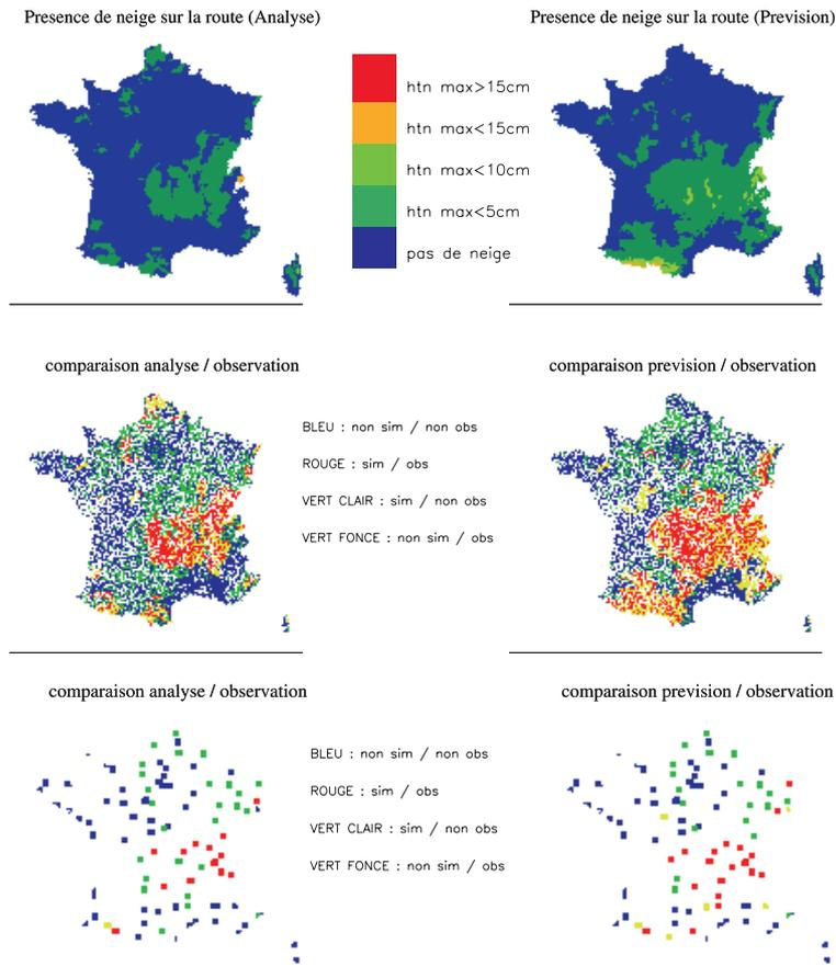
**Figure 6.23 :** Résultat des simulations de présence de neige sur les routes (en haut) avec le forçage analysé et de la prévision pour l'épisode du 24 au 25 janvier 2005. Comparaison de ces résultats avec les occurrences de neige (au milieu) et avec les occurrences de neige au sol (en bas) issues de la base de données climatologiques de Météo-France.
