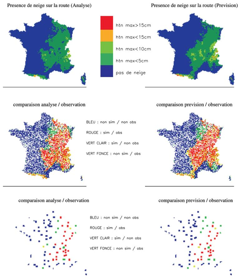
**Figure 6.22 :** Résultat des simulations de présence de neige sur les routes (en haut) avec le forçage analysé et de la prévision pour l'épisode du 28 au 29 décembre 2004. Comparaison de ces résultats avec les occurrences de neige (au milieu) et avec les occurrences de neige au sol (en bas) issues de la base de données climatologiques de Météo-France.
