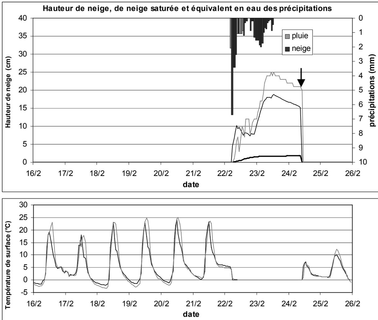
**Figure 4.2 :** Comparaison pour l'épisode 1 a) des hauteurs de neige simulées (trait foncé) et mesurées (trait clair), simulation de la hauteur de neige saturée en eau liquide (trait épais), précipitations (histogramme) et déneigement manuel (↓) b) des températures de surface simulées (trait foncé) et mesurées (trait clair).
