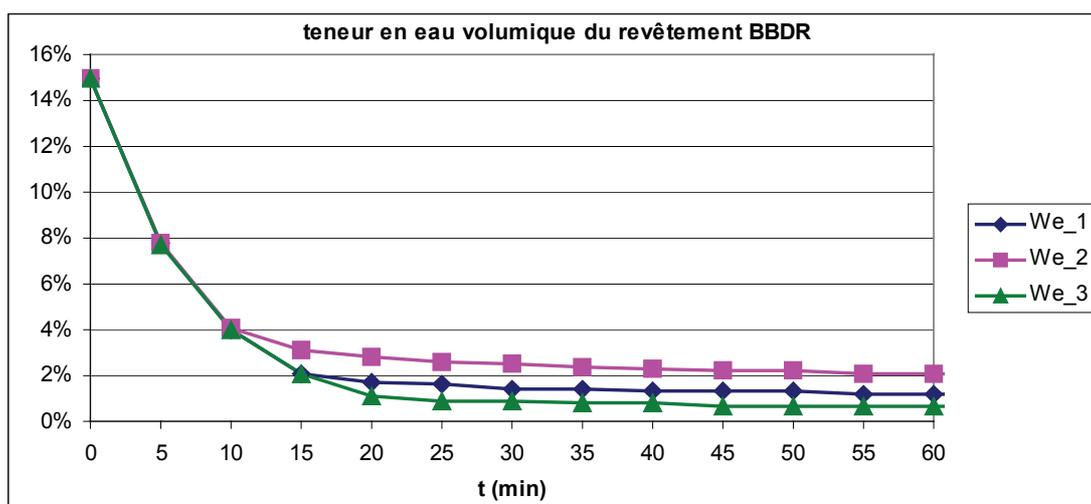
**Figure 4.13** : Comparaison de la teneur en eau liquide volumique au sein d'un revêtement drainant, pour plusieurs valeurs de la conductivité hydraulique à saturation :  $k_{\text{sat}}= 10^{-2} \text{ m.s}^{-1}$  ( $We_1$ ),  $k_{\text{sat}}= 10^{-3} \text{ m.s}^{-1}$  ( $We_2$ ) et  $k_{\text{sat}}= 10^{-1} \text{ m.s}^{-1}$  ( $We_3$ ).
