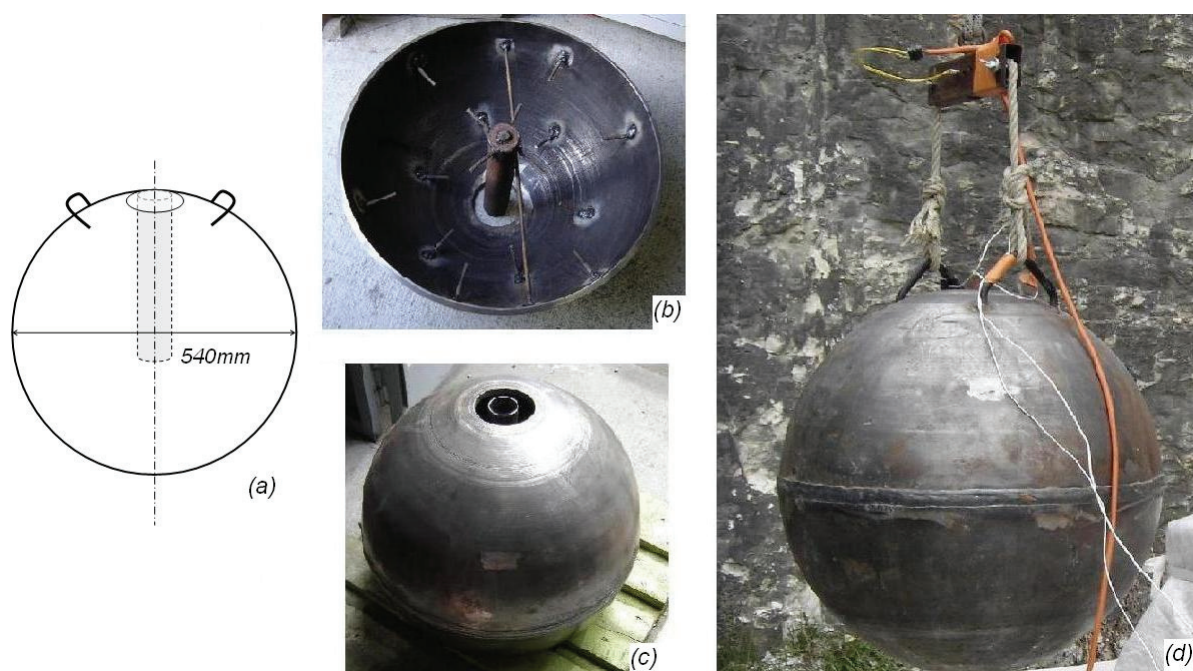
FIG. 5.2 – Impacteur : Vue en perspective (a), vue de la demi-sphère supérieure retournée, révélant le fourreau et les fers de liaison soudés sur la coque (b), sphère avant remplissage (c), et suspendu avec système de fonte de corde et accéléromètres en place (d).
