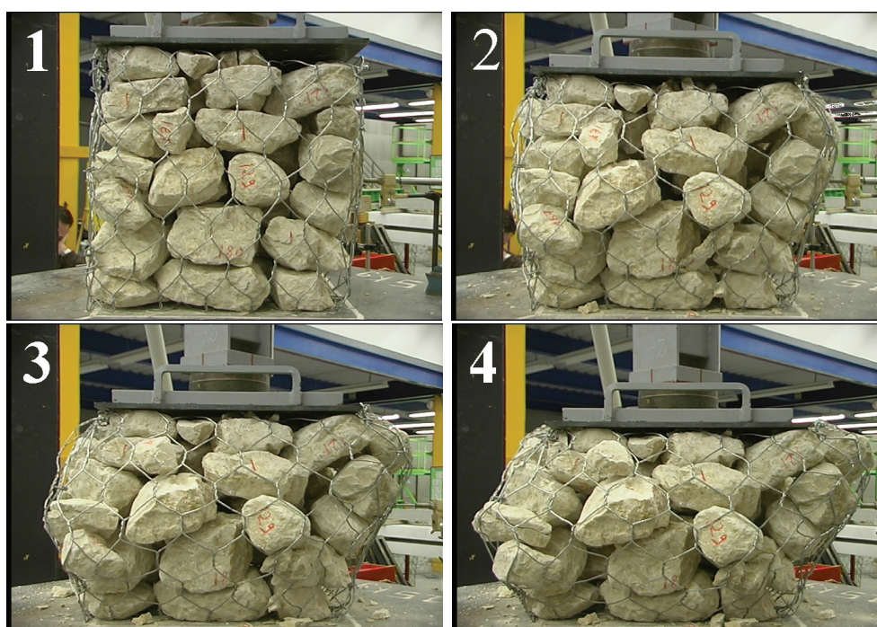
FIG. 4.23 – Cellule 500 granulats en conditions non confiné (série G6) soumise à compression à environ 5, 10, 15 et 20% de déformation axiale (resp. photographie 1, 2, 3 et 4) : Fracture de granulats entre 1 et 2, au centre, forte déformation de la maille à mi-hauteur à partir de 3, et granulat traversant le grillage en 4.
