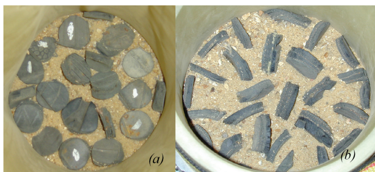
FIG. 3.28 – Préparation des éprouvettes pneu-sable pour les essais triaxiaux avec orientation particulière des pastilles : pastilles alternativement horizontales et verticales (a) et pastilles verticales (b).
