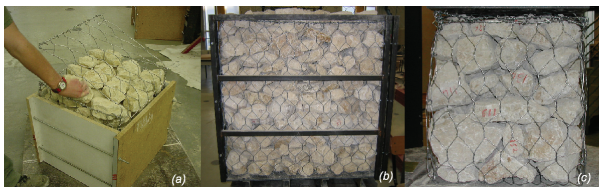
FIG. 4.1 – Lors de son remplissage, la cellule est maintenue dans un coffre (a) ou dans un cadre (b) en fonction de sa taille (300-500/1000mm). On compte en moyenne 6 granulats sur la hauteur, en face latérale d'une cellule 500 granulats (c).
