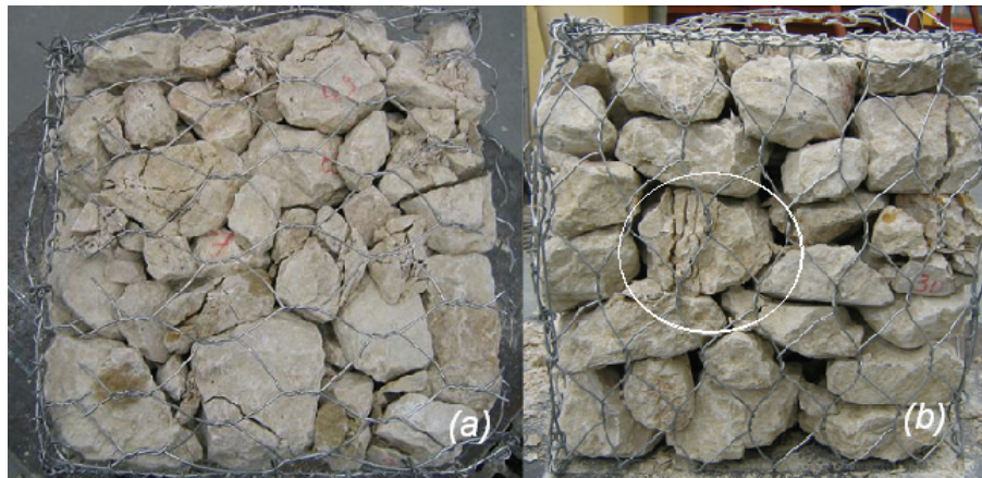
FIG. 4.32 – Cellule 500 granulats confinée après essai : (a) fracturations sur toute la surface chargée et (b) fracturations localisées sur une des faces latérales, dont une caractéristique d'une sollicitation en traction indirecte (cercle).
