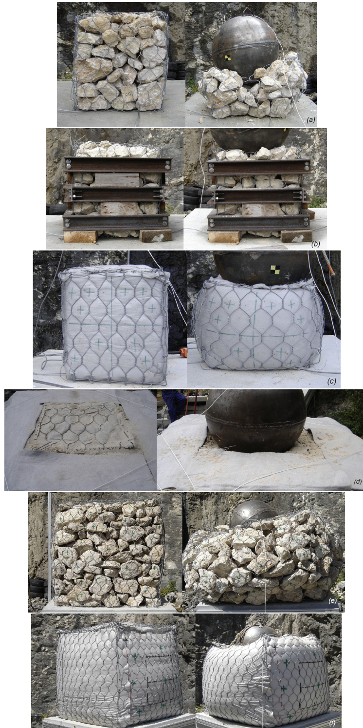
FIG. 5.12 – Cellules avant/après impact : cellules 500 granulats non confinée (a) et confinée (b), cellule 500 sable non confinée (c) et confinée par du matériau (d), cellule 1000 non confinée remplie de granulats (e) et de sable (f).
