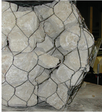
FIG. 4.24 – Effet de voûte lors d'un essai sur cellule 500 granulates en conditions non confinées, en grandes déformations (série G6).
