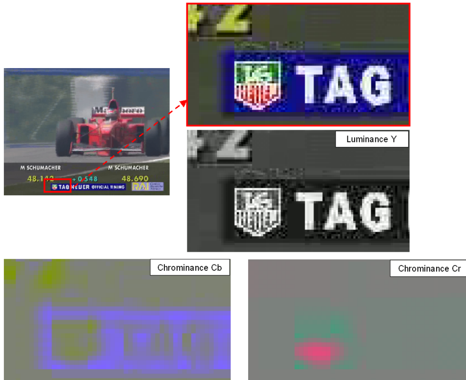
FIG. 1.15 – La décomposition d'une image avec les composantes Y, Cb et Cr.
