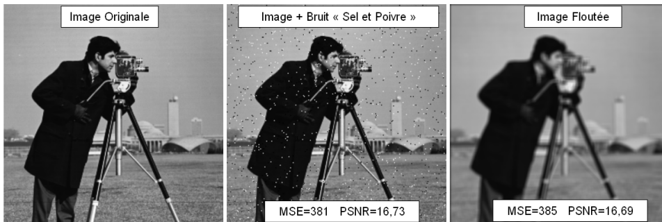
FIG. 3.7 – Défaut du PSNR et du MSE dans l'estimation de la qualité. Par rapport à l'image originale, les deux images bruitées ont une qualité perçue différente mais un PSNR et un MSE très proche.
