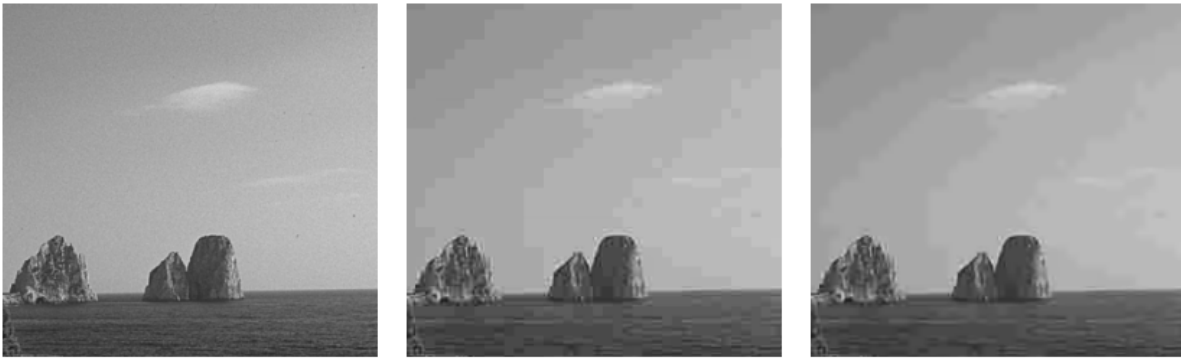
FIG. 2.14 – De gauche à droite : image non compressée, image compressée , image corrigée par filtre moyeneur sur 4 pixels à gauche et à droite de la frontière (les frontières fantômes sont visibles).
