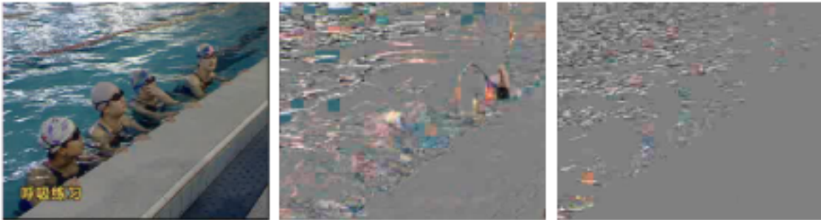
FIG. 1.9 – De gauche à droite : Informations à coder pour une image I, une image P et une image B.
