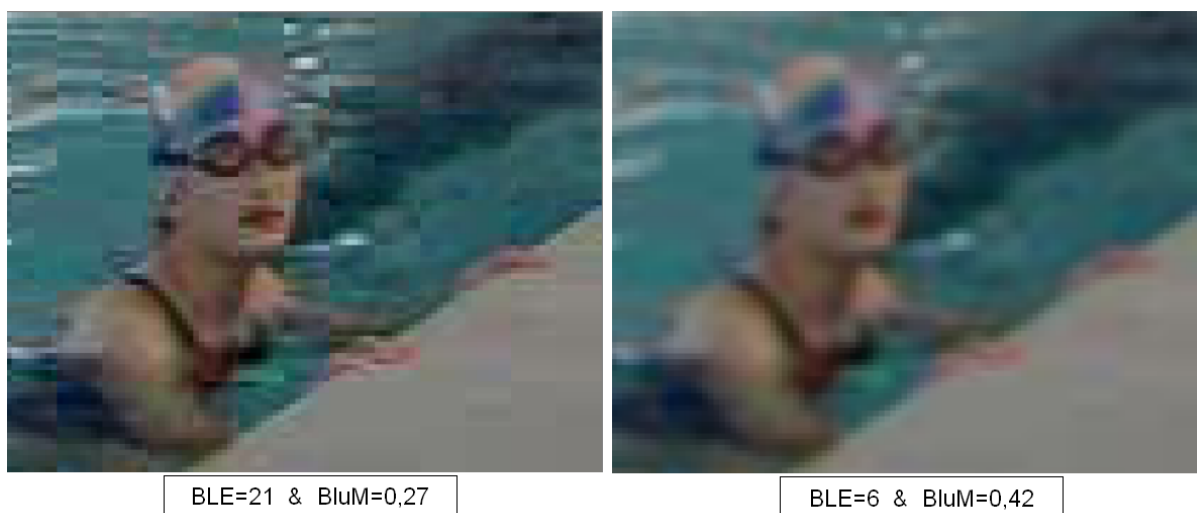
FIG. 5.31 – La métrique de bloc et la métrique de flou pour évaluer la qualité d'une correction.
