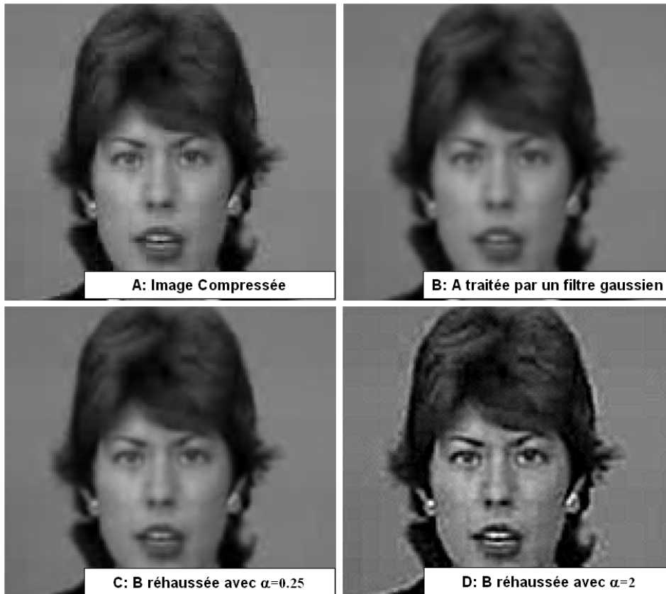
FIG. 2.5 – Exemple de correction de type filtrage et rehaussement. \alpha est le coefficient du filtre de Jarske et al dont le noyau est représenté à l'équation (2.6).
