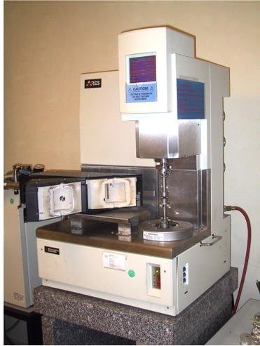
**Figure B.10.** : Rhéomètre ARES à déformation imposée.
