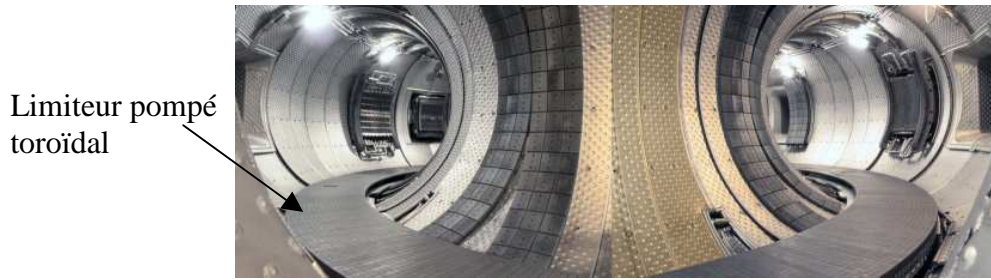
Figure 2 : Intérieur de la chambre toroïdale de Tore Supra
