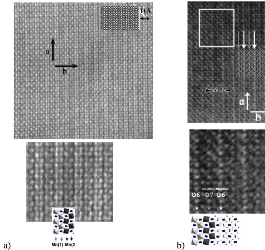
Figure 21 : image haute résolution prises à température ambiante de la structure ordonnée du composé  $\text{Bi}_{0.6}\text{Ca}_{0.4}\text{MnO}_3$  : a) contraste caractéristique : doubles bandes ; b) contraste caractéristique : lignes blanches
