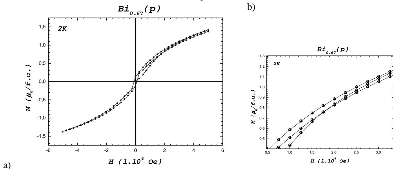
Figure 19: a) Hystérésis présentée par la courbe d'aimantation en fonction du champ appliqué du composé  $\text{Bi}_{0.67}(\text{p})$  à 2K. La partie b) présente un détail de cette courbe où un croisement entre la courbe de montée en champ et de descente en champ est observé. Ce type d'intersection est typique d'un système hors équilibre.
