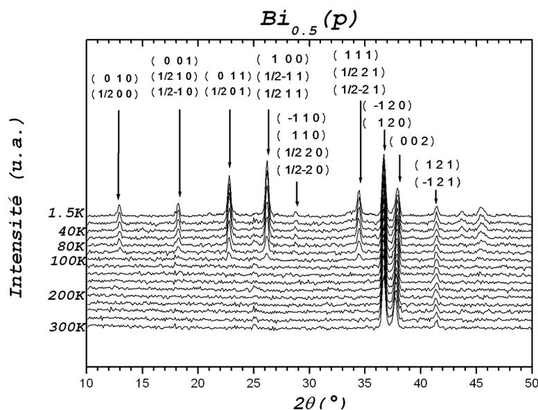
Figure 7: Evolution en fonction de la température des diagrammes de diffraction des neutrons pour le composé  $\text{Bi}_{0.5}\text{Ca}_{0.5}\text{MnO}_3$ . Les indexations sont données dans la maille nucléaire CO/OO  $a_p\sqrt{2}\times 2a_p\sqrt{2}\times 2a_p$ .
