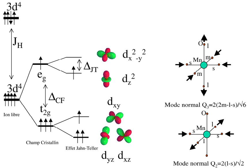
Fig. 3: à gauche : Effet du champ cristallin et effet Jahn – Teller, à droite : modes de vibration des liaisons Mn-O  $Q_2$  et  $Q_3$  n’entraînant pas de modification du volume de l’octaèdre  $MnO_6$  et stabilisant les distorsions du réseau.
