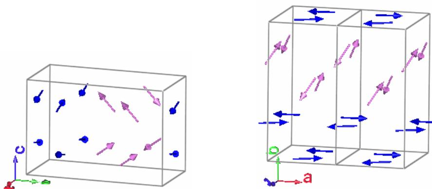
Figure 13: Schémas représentant l'une des structures magnétiques non colinéaires modélisant le diagramme de diffraction du composé Bi<sub>0.5</sub>(p).
