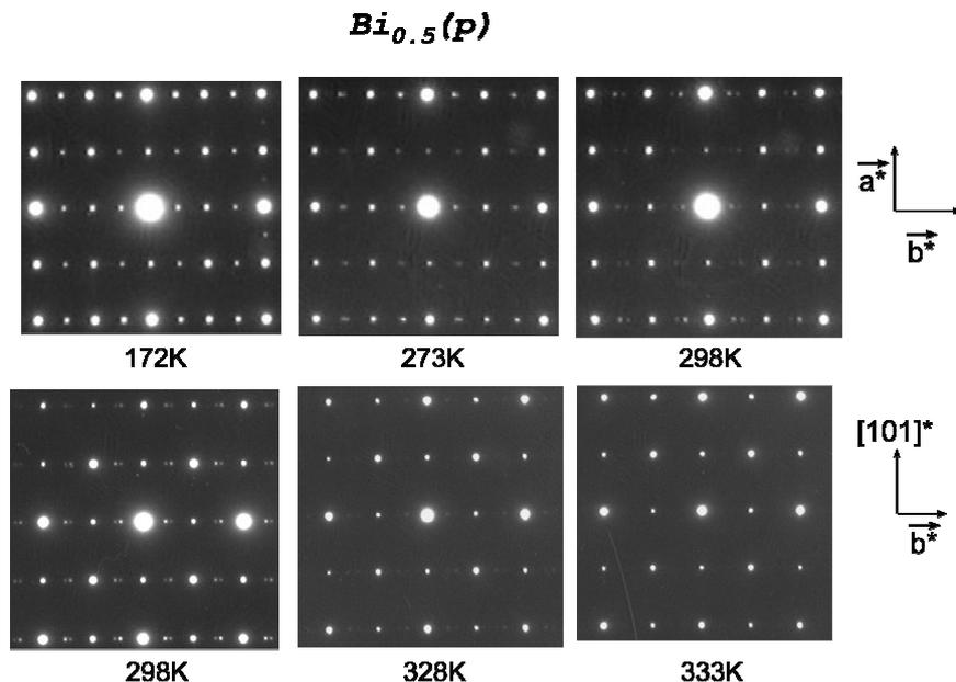
Figure 3: clichés de diffraction électronique pour le composé  $\text{Bi}_{0.5}(\text{p})$  pris en fonction de la température. Les vecteurs du réseau réciproque sont donnés dans la maille haute température de type  $\text{GdFeO}_3$ .
