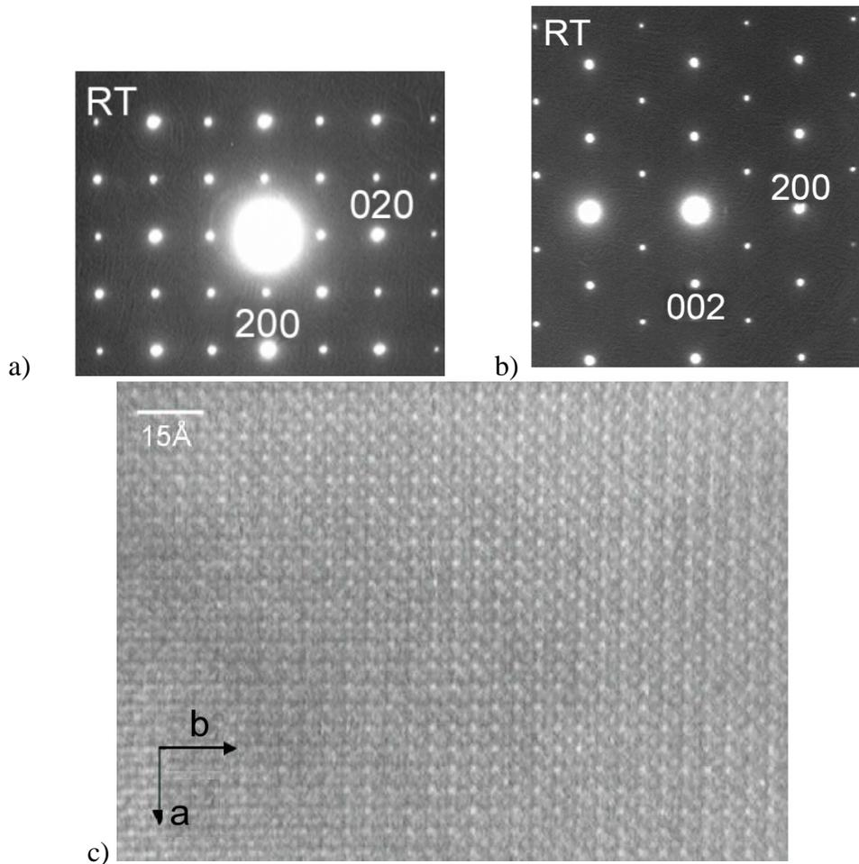
Figure 25 : Clichés de diffraction électronique des plans réciproques (a) (001) et (b) (010) du composé  $\text{Bi}_{0.71}\text{Ca}_{0.24}\text{MnO}_3$  à température ambiante. Image haute résolution orientée (001) (c).
