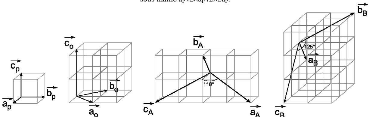
Figure 29: relation entre la maille perovskite cubique (p), la maille orthorhombique de type  $\text{GdFeO}_3$  [4] (o), la maille du composé  $\text{BiMnO}_3$  décrite par Atou *et al* [17] (A) et la maille choisie pour l'affinement de la maille basse température du composé  $\text{Bi}_{0.7}(\text{k})$  (B).
