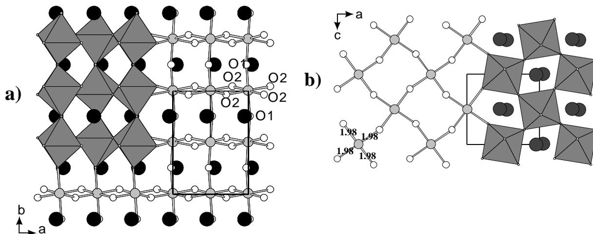
Figure 26 : Projection de la structure à température ambiante de  $\text{Bi}_{0.71}\text{Ca}_{0.24}\text{MnO}_3$  selon  $c$  (a) et selon  $b$  (b).
