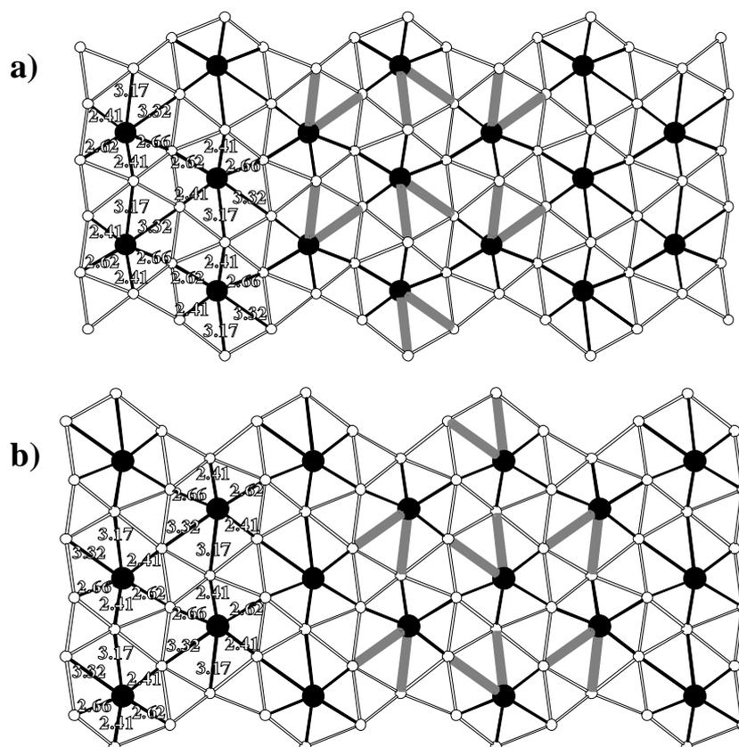
Figure 27: Plans  $[\text{BiO}]$  adjacents empilés selon la direction  $[001]$  de la maille proposée par Atou *et al* [17] pour  $\text{BiMnO}_3$ . Les liaisons Bi-O les plus longues sont matérialisées par des traits gris épais. Les atomes de bismuth et d'oxygène sont représentés respectivement par un disque noir et un petit disque blancs.
