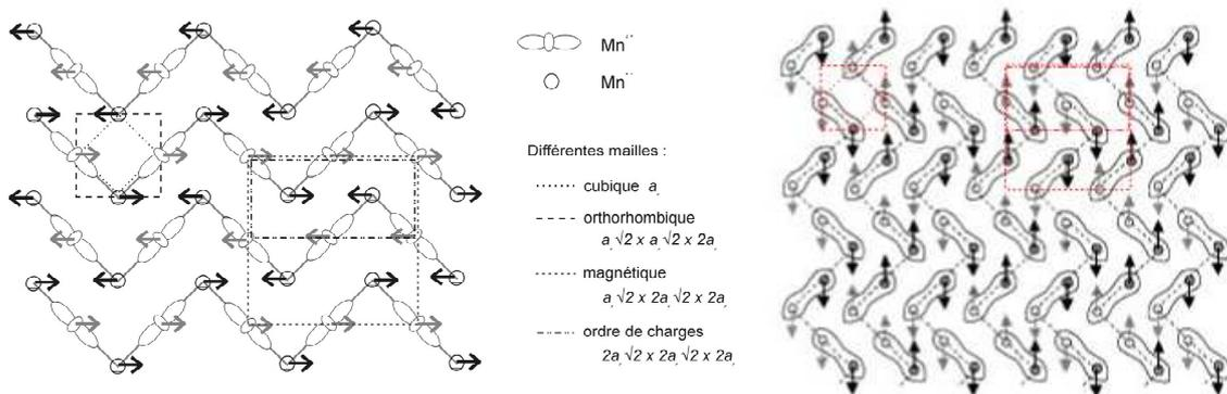
Fig. 12: composés semi dopés : 1) à gauche : modèle de couplage AFM dans le plan a,b de type CE [19], le plan est figuré et suivant l'axe c, les plans a,b sont couplés AFM 2) à droite : modèles des polarons de Zener en accord avec un arrangement des moments magnétiques de type CE, d'après J. Rodriguez-Carvajal [59].
