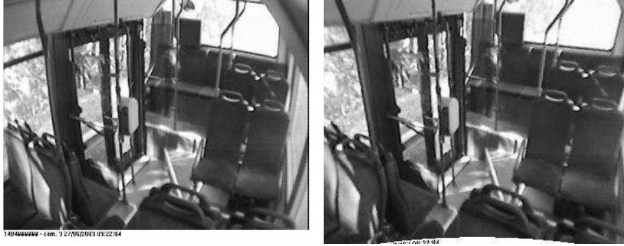
FIG. 2.11 – Correction de la distortion radiale. à gauche : image originale. à droite : image corrigée
