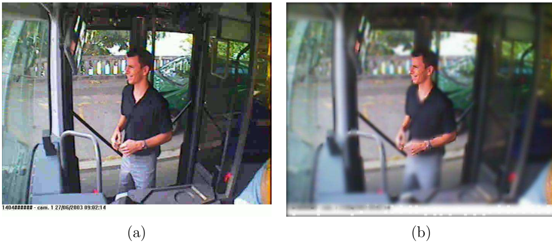
FIG. 7.6 – Comparaison subjective des deux préfiltrages pour une même taille de fichier JPEG de 30ko. (a) : DCT. (b) : gaussien
