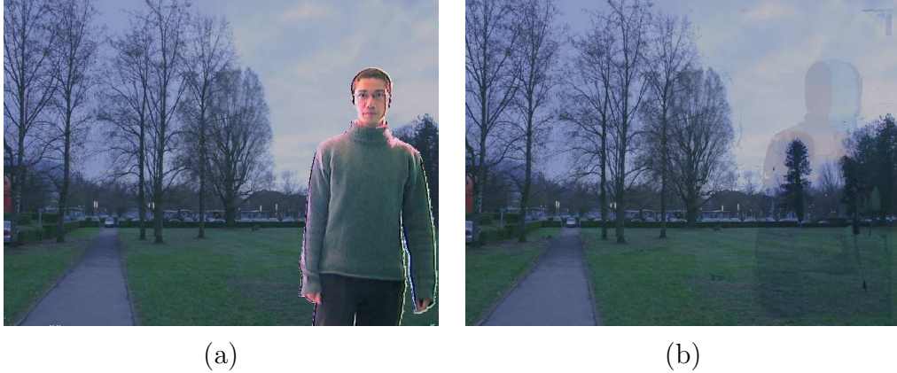
FIG. 5.19 – Estimation de l'arrière-plan par la méthode présentée. (a) : Image originale. (b) :Arrière-plan estimé
