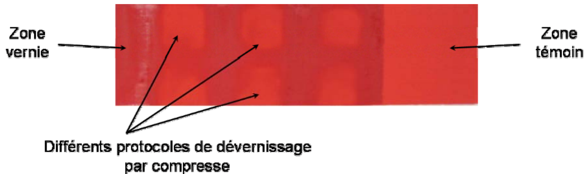
Figure 2 : Echantillons de cinabre (Kremer) sur lesquels est testé le protocole de dévernissage par compresse
