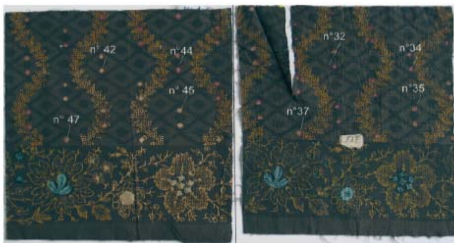
Figure 11 : Deux détails d'indiennes, les zones mesurées avec le GOSPEL sont indiquées
