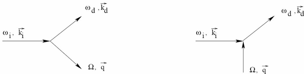
Figure 26 : Représentation schématisée des rayonnements incidents et émis lors d'un processus de diffusion Stokes et anti-Stokes.
