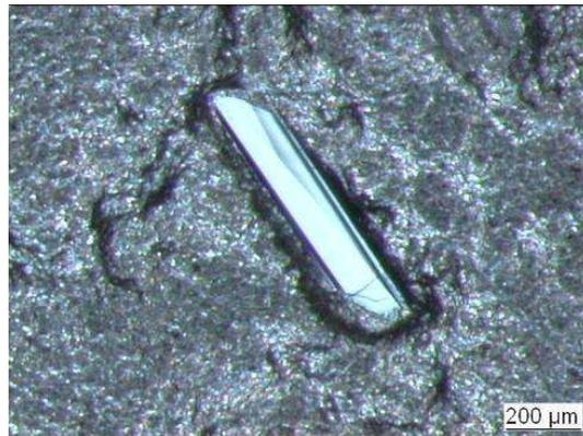
Figure 26 : Monocristal de  $\text{Bi}_{0.45}\text{Dy}_{0.55}\text{FeO}_3$  de forme parallélépipédique de dimensions  $0.75 \times 0.15 \times 0.04\ \text{mm}^3$  observé à la loupe binoculaire. Le cristal est collé à la laque d'argent sur le support d'analyse. La photo montre l'excellent état de surface du cristal.
