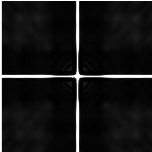
FIG. 5.15 – PSF au plan final d'un système de Fresnel à 300 zones apodisée par T_{trig} , avec une largeur de bande spectrale imagée de \frac{\Delta\lambda}{\lambda} = 0.35 , soit le maximum qui soit autorisé par la dimension de l'optique de champ d'après l'équation 4.10. Les valeurs des images vont de 0 à 65e6 , mais l'affichage se fait ici seulement entre 0 et 250 de façon à faire ressortir les faibles intensités.
