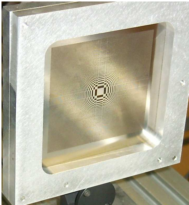
FIG. 6.3 – Ce réseau de Fresnel comporte 58 zones, soit 26680 ouvertures ( 8N^2-4N ). La distance focale à l'ordre 1 est de 23m@600nm . Un choc de la surface est visible sur l'image, sur l'aigrette droite de la grille. Cette déformation est sans incidence sur la qualité du front d'onde émergent grâce à comme expliqué au chapitre 2 la haute tolérance de positionnement des ouvertures.
