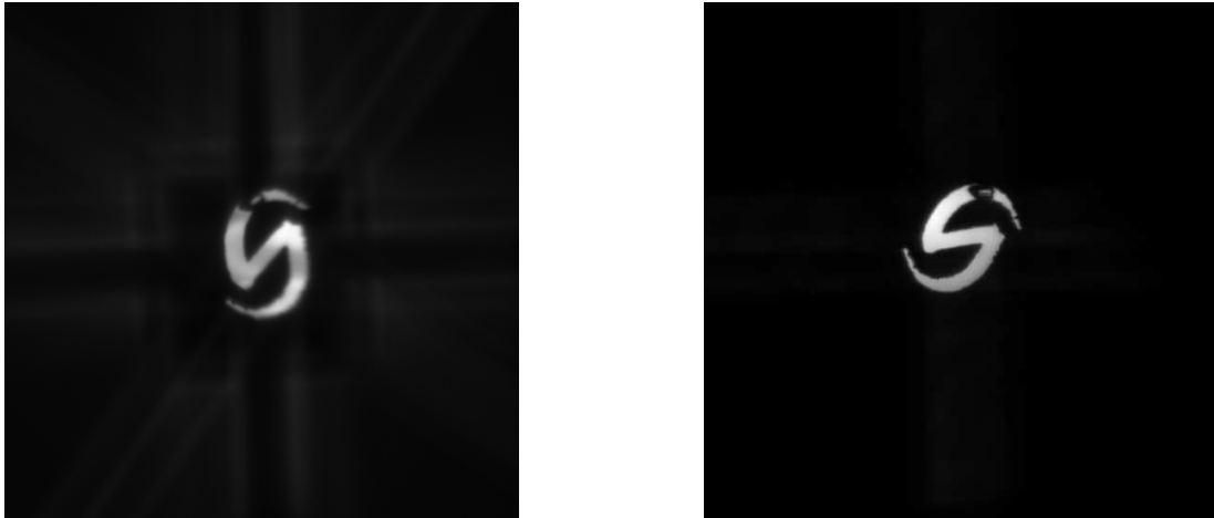
FIG. 7.1 – Image de la mire "galaxie" au foyer terminal, en utilisant un réseau correcteur non blazé. L'imagerie est polychromatique, la source lumineuse étant une source halogène. Les jeux d'aigrettes des deux grilles de Fresnel sont visibles, tournées de 40 degrés l'un par rapport à l'autre. La diffraction de l'ordre 0 du réseau primaire sur les bords du masque d'ordre 0, imagé par l'ordre 0 du réseau correcteur, est également visible. Les défauts de découpe de la mire sont visibles sur les bords de découpe et par un élément de métal "coincé" dans un bras de la galaxie.
