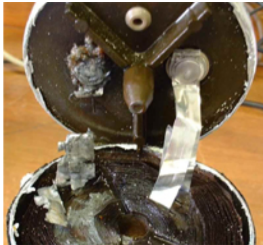
Figure 4.6 : Corrosion de l'anode d'un condensateur 4700 \mu\text{F} , 500 V [1]
