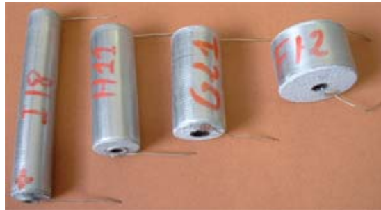
Figure 4.13 : Photo de quelques condensateurs utilisés
