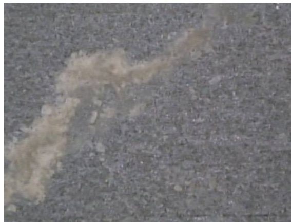
Figure 4.5 : Anode d'un condensateur 4700 \mu F, 500 V, après 500 cycles (X200) [1]
