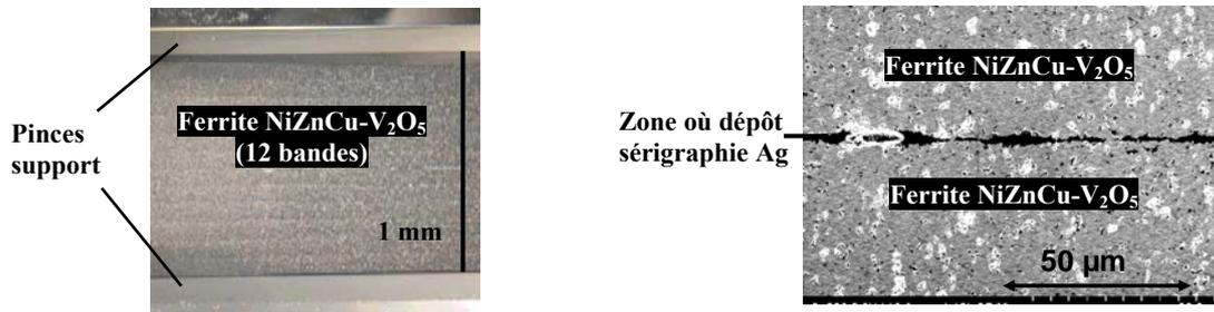
Figure 4-38 : photos réalisées sur l'empilement «6 bandes NiZnCu-V<sub>2</sub>O<sub>5</sub> / Ag / 6 bandes NiZnCu-V<sub>2</sub>O<sub>5</sub>» : (à gauche) image optique de l'empilement - (à droite) image MEB de l'empilement.
